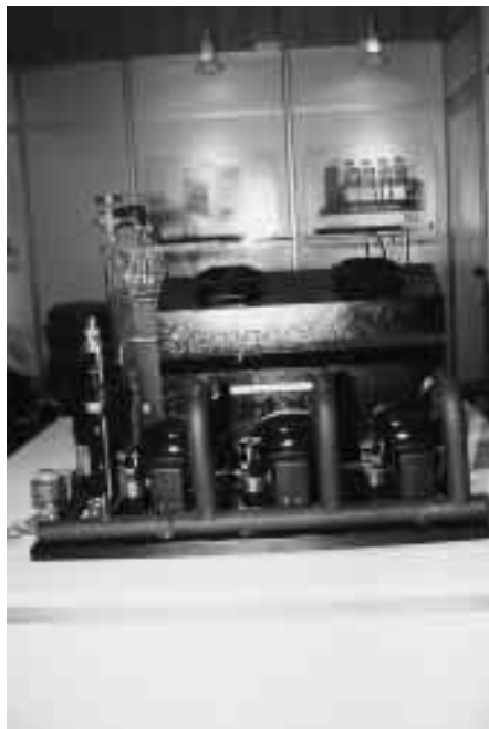
Die wohl kleinste – funktionierende – Verbundanlage zeigte demonstrativ die kompakt Kältetechnik aus Dresden. Kälteleistung etwa 400 Watt.
