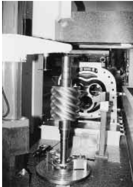
Die richtige „Schraube“ von Grasso mit Entwicklungsleiter Dr. Mosemann im Versuchsfeld. Auf die Details kommt es ihm an: Asymmetrisch abwälzbares Rotorprofil, dynamische Gestaltung des Außengehäuses, Vi-Teillastverstellung mit eigener Vi-Regelstrategie, optimierter Ansaugkanal und Gasschwingungsschutz für große Druckverhältnisse.
