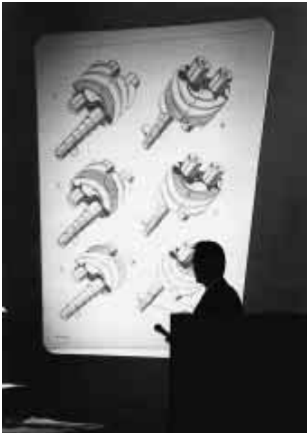
Die richtige „Schraube“ von Grasso mit Entwicklungsleiter Dr. Mosemann im Versuchsfeld. Auf die Details kommt es ihm an: Asymmetrisch abwälzbares Rotorprofil, dynamische Gestaltung des Außengehäuses, Vi-Teillastverstellung mit eigener Vi-Regelstrategie, optimierter Ansaugkanal und Gasschwingungsschutz für große Druckverhältnisse.
