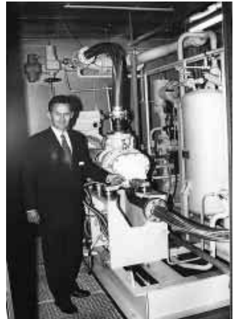
Die richtige „Schraube“ von Grasso mit Entwicklungsleiter Dr. Mosemann im Versuchsfeld. Auf die Details kommt es ihm an: Asymmetrisch abwälzbares Rotorprofil, dynamische Gestaltung des Außengehäuses, Vi-Teillastverstellung mit eigener Vi-Regelstrategie, optimierter Ansaugkanal und Gasschwingungsschutz für große Druckverhältnisse.
