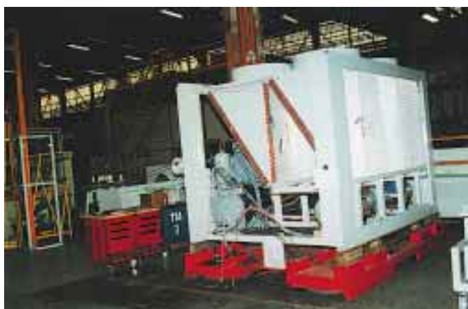
Eindrücke aus der Fertigung und während der „Global Chiller“-Endmontage. Durch die „W-Anordnung“ der Wärmetauscherflächen bei der luftgekühlten Ausführung läßt sich das Verflüssigervolumen um durchschnittlich 30 % verringern. Sowohl bei der wassergekühlten als auch bei der luftgekühlten Ausführung kommen überflutete Verdampfer zum Einsatz, durch deren Konstruktion sich die Temperaturunterschiede zwischen den Medien R 134a und Wasser bis auf 1K reduzieren lassen.
