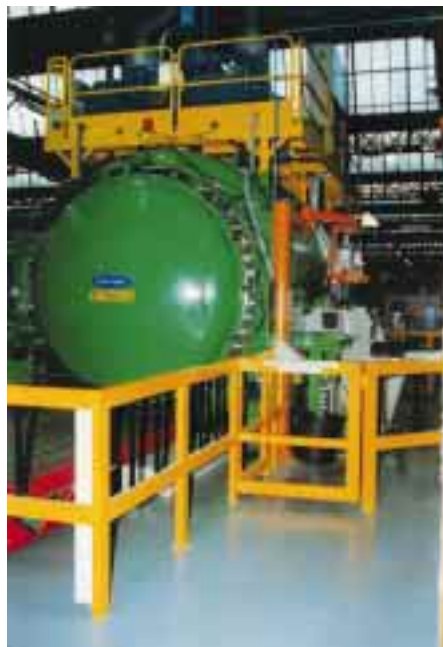
Bereits Ende 1995 hat Carrier in seinem Werk in Montluel in der Nähe von Lyon eine „Druckluft-Versuchskabine“ in Betrieb genommen, um hierin die Wärmetauscher des „Global Chiller“ zu testen. 3 Millionen Francs wurden für diese Eigenentwicklung investiert. Die Druckluftkabine für die Teststarts hat einen Durchmesser von 4 Metern, ist 7 Meter lang und wiegt 32 Tonnen.
