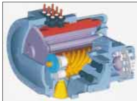
Das Herz des „Global Chiller“, der von Carrier in den USA entwickelte „Power 3 -Schraubenverdichter. Er besitzt eine Doppelrotor-Schraubenverdichtung und eine neuartige Getriebetechnologie, die Drehzahlen von 10 000 min -1 ermöglicht. In Relation zu einem Hubkolbenverdichter ist die neue Carrier-Schraube um das Dreifache kompakter.
