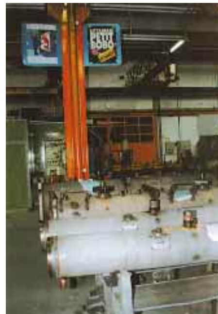
Bereits Ende 1995 hat Carrier in seinem Werk in Montluel in der Nähe von Lyon eine „Druckluft-Versuchskabine“ in Betrieb genommen, um hierin die Wärmetauscher des „Global Chiller“ zu testen. 3 Millionen Francs wurden für diese Eigenentwicklung investiert. Die Druckluftkabine für die Teststarts hat einen Durchmesser von 4 Metern, ist 7 Meter lang und wiegt 32 Tonnen.
