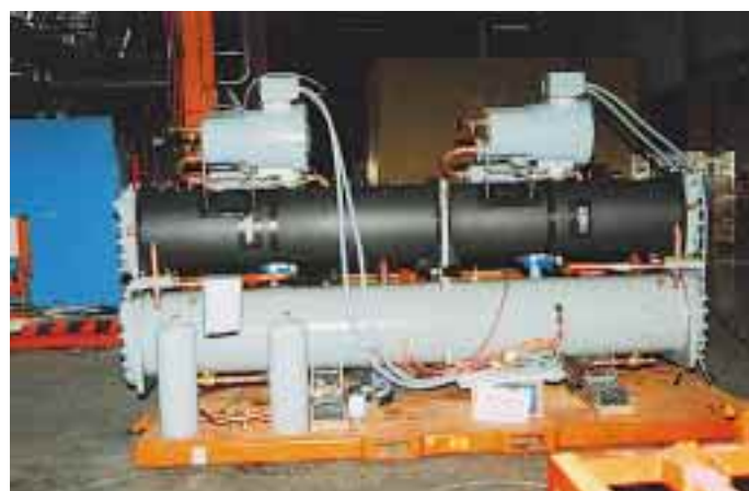
Eindrücke aus der Fertigung und während der „Global Chiller“-Endmontage. Durch die „W-Anordnung“ der Wärmetauscherflächen bei der luftgekühlten Ausführung läßt sich das Verflüssigervolumen um durchschnittlich 30 % verringern. Sowohl bei der wassergekühlten als auch bei der luftgekühlten Ausführung kommen überflutete Verdampfer zum Einsatz, durch deren Konstruktion sich die Temperaturunterschiede zwischen den Medien R 134a und Wasser bis auf 1K reduzieren lassen.
