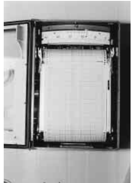
KÜBA's Entwicklungsingenieur auf dem Elektronik- und Steuerungssektor, Friedhelm Meyer, und Anlagenersteller Uwe Stedler, Kälteanlagenbauer aus Werbellin, bei Inspektionsarbeiten am Schaltschrank. Auf dem rechten Bild ist einer der Temperaturschreiber zu sehen und es ist abzulesen, daß die Lagertemperatur „geradlinig“ -26°/-28 °C beträgt.
