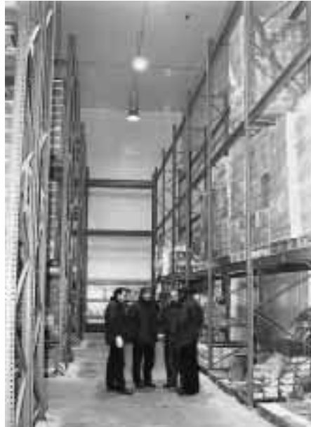
Blick in die beiden Hochregallager von Langnese-Iglo in Berlin Wartenberg. 9 Meter Höhe stehen dort zu Verfügung, die Stellfläche beträgt 232\text{ m}^2 und 392\text{ m}^2 . Das bedeutet 198 Paletten-Grundstellplätze für die Kommissionierung und 630 Vorratsstellplätze. Das durchschnittliche Palettengewicht beträgt 600\text{ kg} . Lagertemperatur -26^{\circ}/-28\text{ }^{\circ}\text{C} – und nicht weniger.
