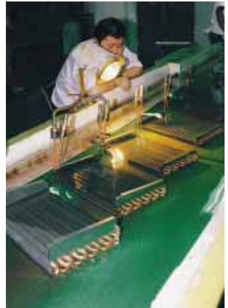
Wärmetauscher-Fertigung für die Klimageräte-Produktion von SANYO Singapur. Qualitäts- und Dichtepfung. 500 000 Stückeinheiten werden produziert. Marktanteil in Singapur: mehr als 50 %.
