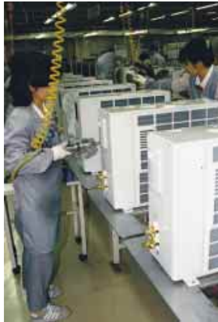
Am „laufenden Band“. Auf 55 075 m 2 Fläche werden 600 Variationen von Klimageräten geplant, entwickelt, gemanagt, gefertigt und versandt. Hier Teilansichten der Fertigung und Leistungsprüfung von Verflüssigereinheiten.
