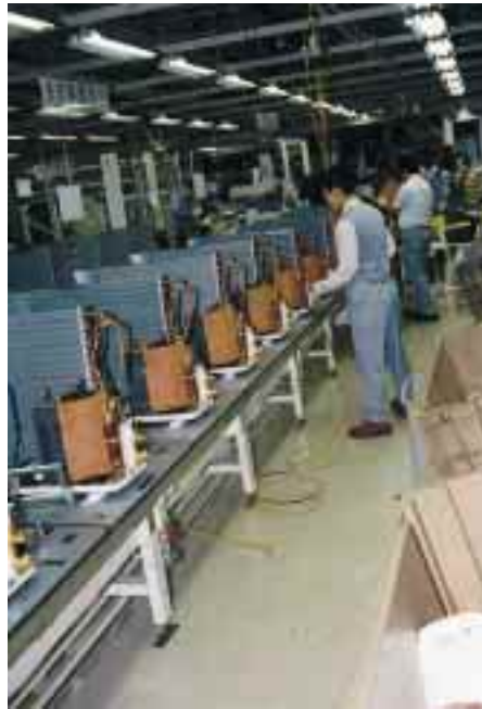
Am „laufenden Band“. Auf 55 075 m 2 Fläche werden 600 Variationen von Klimageräten geplant, entwickelt, gemanagt, gefertigt und versandt. Hier Teilansichten der Fertigung und Leistungsprüfung von Verflüssigereinheiten.
