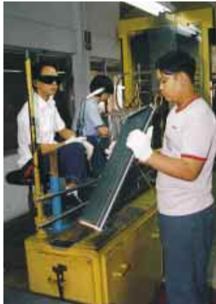
Wärmetauscher-Fertigung für die Klimageräte-Produktion von SANYO Singapur. Qualitäts- und Dichtepfung. 500 000 Stückeinheiten werden produziert. Marktanteil in Singapur: mehr als 50 %.
