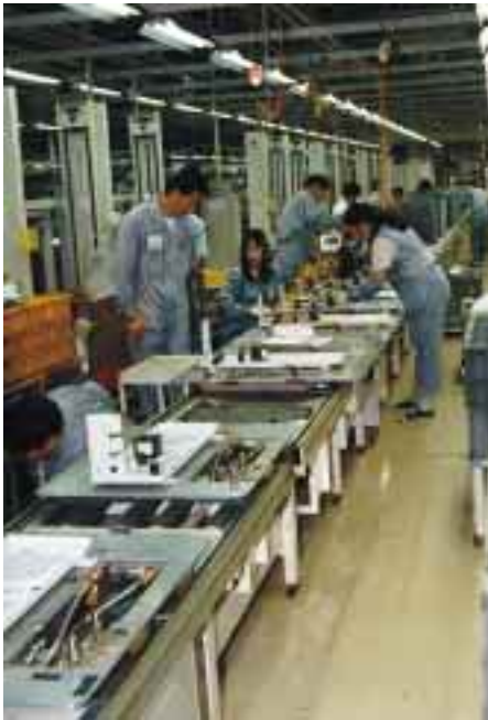
Am „laufenden Band“. Auf 55 075 m 2 Fläche werden 600 Variationen von Klimageräten geplant, entwickelt, gemanagt, gefertigt und versandt. Hier Teilansichten der Fertigung und Leistungsprüfung von Verflüssigereinheiten.
