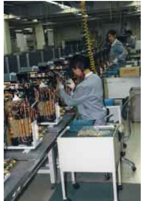
Am „laufenden Band“. Auf 55 075 m 2 Fläche werden 600 Variationen von Klimageräten geplant, entwickelt, gemanagt, gefertigt und versandt. Hier Teilansichten der Fertigung und Leistungsprüfung von Verflüssigereinheiten.
