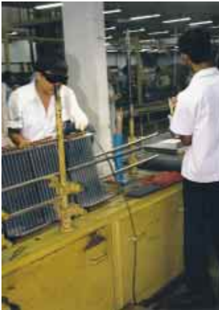
Wärmetauscher-Fertigung für die Klimageräte-Produktion von SANYO Singapur. Qualitäts- und Dichtepfung. 500 000 Stückeinheiten werden produziert. Marktanteil in Singapur: mehr als 50 %.
