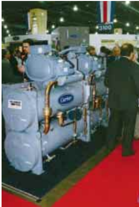
Welche „Schraube“ ist die richtige? KK will dies hier nicht bewerten. Tatsächlich verdrängt der Schraubenverdichter immer mehr den Hubkolbenverdichter speziell bei der Fertigung von kompakten Flüssigkeitskühlern. Die linke Abbildung zeigt den „Global Chiller“ von Carrier (Kältemittel R 134a), das mittlere Bild eine Schraubenverdichtereinheit von Grasso (Kältemittel NH 3 ), auf dem rechten Bild ist ein Schnittmodell der McQuay-Schraube „geöffnet“ (Kältemittel R 22 oder R 134a).
