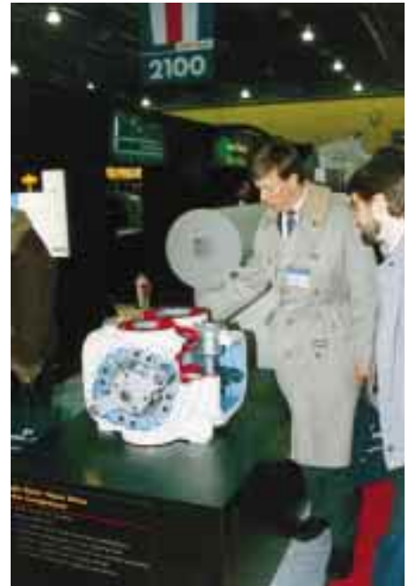
Welche „Schraube“ ist die richtige? KK will dies hier nicht bewerten. Tatsächlich verdrängt der Schraubenverdichter immer mehr den Hubkolbenverdichter speziell bei der Fertigung von kompakten Flüssigkeitskühlern. Die linke Abbildung zeigt den „Global Chiller“ von Carrier (Kältemittel R 134a), das mittlere Bild eine Schraubenverdichtereinheit von Grasso (Kältemittel NH 3 ), auf dem rechten Bild ist ein Schnittmodell der McQuay-Schraube „geöffnet“ (Kältemittel R 22 oder R 134a).
