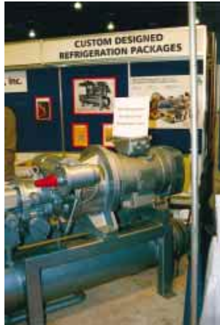
Welche „Schraube“ ist die richtige? KK will dies hier nicht bewerten. Tatsächlich verdrängt der Schraubenverdichter immer mehr den Hubkolbenverdichter speziell bei der Fertigung von kompakten Flüssigkeitskühlern. Die linke Abbildung zeigt den „Global Chiller“ von Carrier (Kältemittel R 134a), das mittlere Bild eine Schraubenverdichtereinheit von Grasso (Kältemittel NH 3 ), auf dem rechten Bild ist ein Schnittmodell der McQuay-Schraube „geöffnet“ (Kältemittel R 22 oder R 134a).
