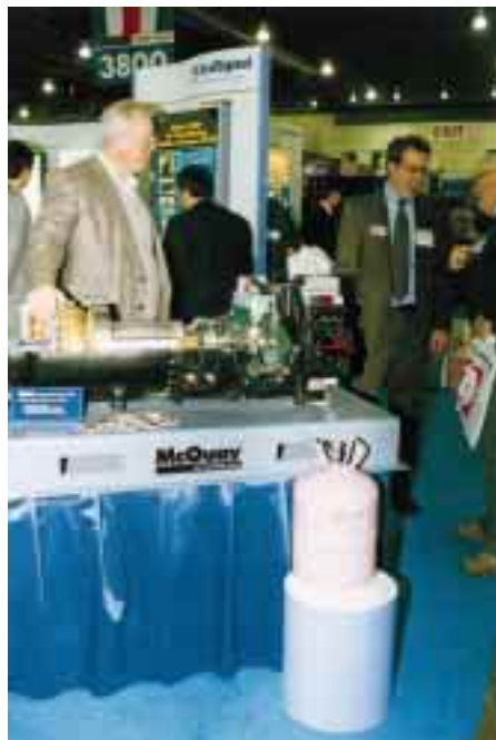
R 410A heißt das Hochdruckkältemittel, das R 22 langfristig ersetzen wird. Es wurde als 50/50 % Blend von Allied Signal aus den Komponenten R 32/R 125 unter der Markenbezeichnung AZ 20 entwickelt. In den USA dient es für einige Produkte (links eine Verflüssigereinheit von Carrier, rechts ein Schraubenverdichtermmodell von McQuay) schon als Standard-Kältemittel trotz seiner hohen Drucklage. Dr. Wiethoff, Copeland President Europe, ist stolz auf die millionenfach bewährte Compliance-Scroll-Technologie. R 410A? In der Klima-Kälte no problem sondern für Copeland-Scrolls fast usual.
