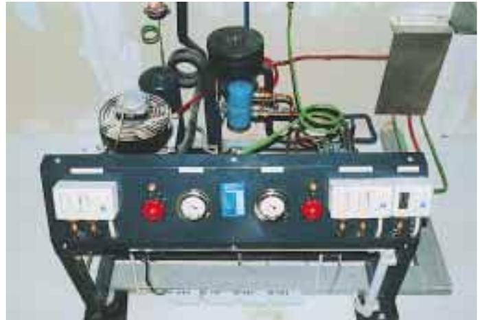
Maschinenrahmen mit NK- und TK-Verdichter sowie übersichtlicher Armatureninstallation.
