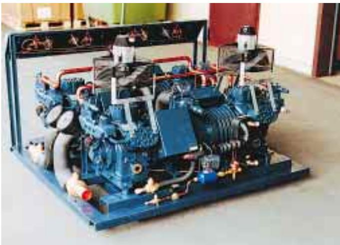
Vor der Auslieferung. Erba Kälte Tandem-Verbundsatz im Supermarkt in Donauwörth mit DORIN-Tandem-Verdichtern TK3000CS-E und TK3000CB-E mit Kopflüfern. Leistung Normalkühlung 58,8 kW, Leistung Tiefkühlung 19,6 kW. Gut zu sehen ist die angebaute Unterkühler-Einheit mit einer Leistung von 5,9 kW.
