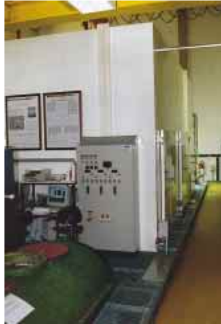
Alles vernetzt für die zweiwöchige Meßkampagne unter der Leitung von Dr. Peter Rockel. Welchen Einfluß hat Ozon auf die Physiologie von Pflanzen? Welche Wechselwirkungen bestehen beim Austausch von Spurenstoffen und der Atmosphäre? Eine dreigeteilte Spezialkühlzelle von Viessmann (7,50 × 3,00 × 4,00 m hoch) diente für die Messungen als Klimakammer.
