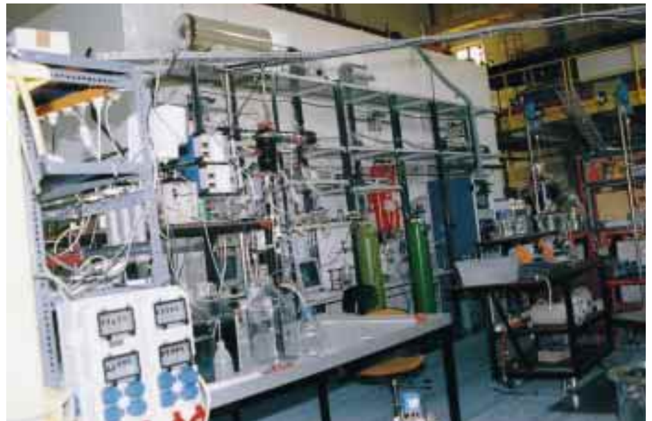
Alles vernetzt für die zweiwöchige Meßkampagne unter der Leitung von Dr. Peter Rockel. Welchen Einfluß hat Ozon auf die Physiologie von Pflanzen? Welche Wechselwirkungen bestehen beim Austausch von Spurenstoffen und der Atmosphäre? Eine dreigeteilte Spezialkühlzelle von Viessmann (7,50 × 3,00 × 4,00 m hoch) diente für die Messungen als Klimakammer.
