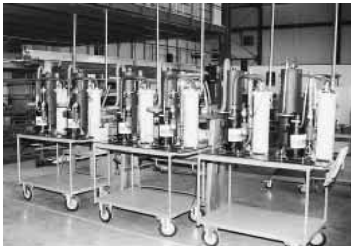
Die „Innereien“. Das linke Bild zeigt Maschinensätze mit R 134a-Scrollverdichtern in Heiz- und Brauchwasser-Wärmepumpen für die Einfamilien-Wohnhaus-Nutzung, das rechte Bild einen Tandem-Kaltwassersatz mit R 134a-Hermetik-Verdichtern. Alles „made by Bertuleit & Bökenkröger“.
