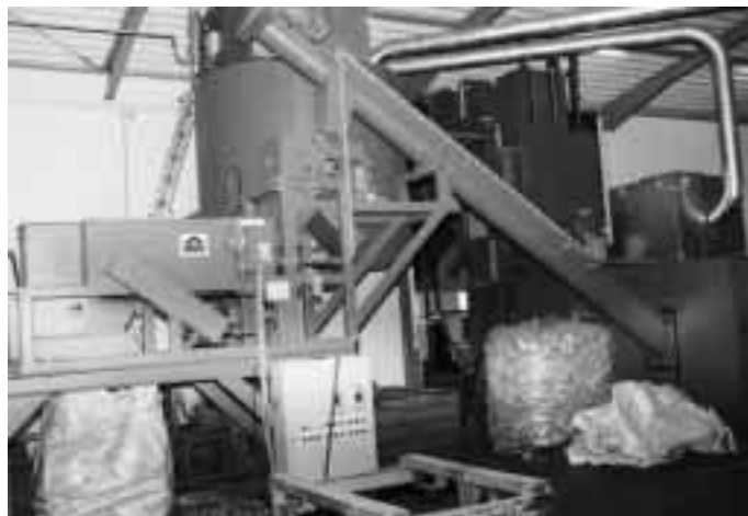
Am Beispiel der Aufbereitung von Haushaltskühlschränken erklärt ENVIPROTECT-Geschäftsführerin Barbara Linke die Hauptfunktion des Vakuumschredders (Fabrikat Adelmann): „Vom Außenlager aus werden sowohl die von den Kälteaggregaten befreiten Kühlgeräte als auch PUR-Dämmelemente in der Halle auf ein horizontales Transportband gelegt. Das nachfolgende Steigeband (Abb. oben rechts) transportiert diese Inputmaterialien in einen Vakuumschredder (Abb. unten rechts), dessen Beschickungsklappe bei Vollfüllung hermetisch geschlossen wird. Im Shredder werden die Verbundmaterialien auf eine Korngröße < 50 mm mit einer Rotorschere zerkleinert und der FCKW-haltige PUR-Schaum freigelegt. Eine Austragsschnecke befördert die zerkleinerten Materialien in einen Windsichter. Die Leichtfraktion wird in ein Vorratssilo mit aufgesetztem Staubfilter geblasen, die Schwerfraktion wird maschinell sortiert (siehe Verfahrensschema in der Abb. links unten).
