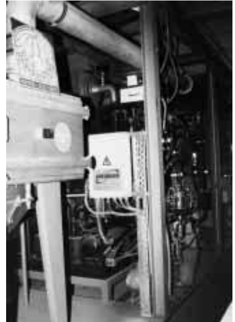
Zur Rückgewinnung der FCKW aus dem PUR-Schaum wird das Material aus dem Silo mit einer Förderschnecke zur vollgekapselten Zerkleinerungseinrichtung transportiert und in einer nachgeschalteten Kolbenstrangpresse hochverdichtet. ENVIPROTECT-Betriebsleiter Heinrich Hirschfeld: „Mit einer Transportschnecke wird der komprimierte PUR-Schaum, der fast vollständig FCKW-frei ist, in Big-Bags abgeworfen und bis zum Abtransport zur Wiederverwertung zwischengelagert.“
