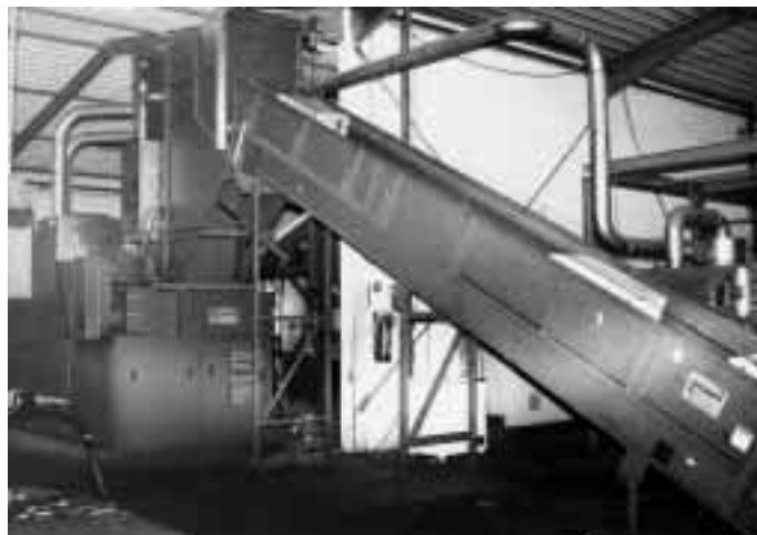
Am Beispiel der Aufbereitung von Haushaltskühlschränken erklärt ENVIPROTECT-Geschäftsführerin Barbara Linke die Hauptfunktion des Vakuumschredders (Fabrikat Adelmann): „Vom Außenlager aus werden sowohl die von den Kälteaggregaten befreiten Kühlgeräte als auch PUR-Dämmelemente in der Halle auf ein horizontales Transportband gelegt. Das nachfolgende Steigeband (Abb. oben rechts) transportiert diese Inputmaterialien in einen Vakuumschredder (Abb. unten rechts), dessen Beschickungsklappe bei Vollfüllung hermetisch geschlossen wird. Im Shredder werden die Verbundmaterialien auf eine Korngröße < 50 mm mit einer Rotorschere zerkleinert und der FCKW-haltige PUR-Schaum freigelegt. Eine Austragsschnecke befördert die zerkleinerten Materialien in einen Windsichter. Die Leichtfraktion wird in ein Vorratssilo mit aufgesetztem Staubfilter geblasen, die Schwerfraktion wird maschinell sortiert (siehe Verfahrensschema in der Abb. links unten).
