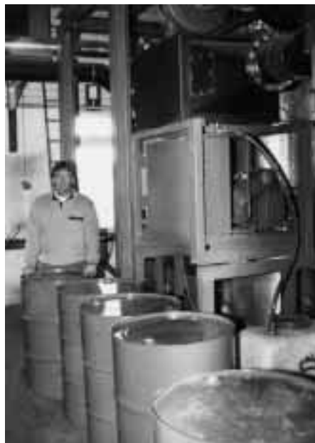
Die bei der Verdichtung in der Kolbenstrangpresse freiwerdende FCKW-haltige Abluft wird in einem Kompressor verdichtet. Die FCKW in der Abluft werden in einer Kälteanlage (siehe Abb. rechts oben und links unten) auskondensiert und in FCKW-Behältern bis zum Abtransport gelagert.
