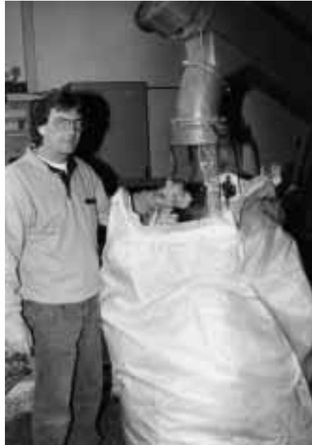
Zur Rückgewinnung der FCKW aus dem PUR-Schaum wird das Material aus dem Silo mit einer Förderschnecke zur vollgekapselten Zerkleinerungseinrichtung transportiert und in einer nachgeschalteten Kolbenstrangpresse hochverdichtet. ENVIPROTECT-Betriebsleiter Heinrich Hirschfeld: „Mit einer Transportschnecke wird der komprimierte PUR-Schaum, der fast vollständig FCKW-frei ist, in Big-Bags abgeworfen und bis zum Abtransport zur Wiederverwertung zwischengelagert.“
