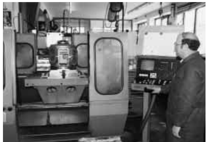
Gehäusebearbeitung für GOELDNER-4 Zylinder-Verdichter durch Präzisionsmaschinen bei HKT Huber-Kälte-Technik in Halfing.
