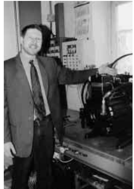
„Schaut's her“, freut sich HKT-Chef Karl Huber, „was unser Goeldner-Verdichter HS 54 3/30 (22 kW) alles kann“. Hier (auf dem linken Bild) ist die Laufruhe (Probelauf auf der Werkbank) angesprochen. Das 5-DM-Stück bleibt senkrecht auf dem Hochdruckventil (rechts neben der Hand) ganz ruhig stehen. Die Kälteleistung beträgt mit den Kältemitteln R 507 oder R 22 ca. 90 kW ( t_o \pm 0^\circ C ), die untere Einsatzgrenze liegt bei -45^\circ C .
