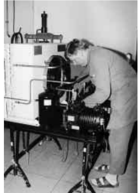
Ein technischer Leckerbissen. Als Einzelauftrag gefertigtes luftgekühltes Spezialaggregat (Normal- und Tiefkühlung) für die Firma Rieger. Drei Verdichter auf einem Chassis; einer davon bestimmt zur Tiefkühlung mit Kältemittel R 507 (Kälteleistung 1,4 kW bei -30^\circ/45^\circ \text{C} ), zwei Verdichter für die Normalkühlung mit Kältemittel R 134a (Kälteleistung -8^\circ/45^\circ \text{C} ). Verflüssiger mit zwei Kreisläufen.
