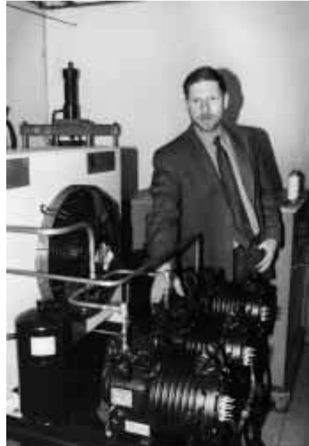
Ein technischer Leckerbissen. Als Einzelauftrag gefertigtes luftgekühltes Spezialaggregat (Normal- und Tiefkühlung) für die Firma Rieger. Drei Verdichter auf einem Chassis; einer davon bestimmt zur Tiefkühlung mit Kältemittel R 507 (Kälteleistung 1,4 kW bei -30^\circ/45^\circ \text{C} ), zwei Verdichter für die Normalkühlung mit Kältemittel R 134a (Kälteleistung -8^\circ/45^\circ \text{C} ). Verflüssiger mit zwei Kreisläufen.
