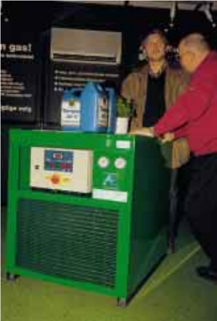
Auf der parallel zu der Fachtagung durchgeführten Ausstellung wurde unter anderem dieser mit Propan arbeitende Kaltwassersatz vorgestellt.
