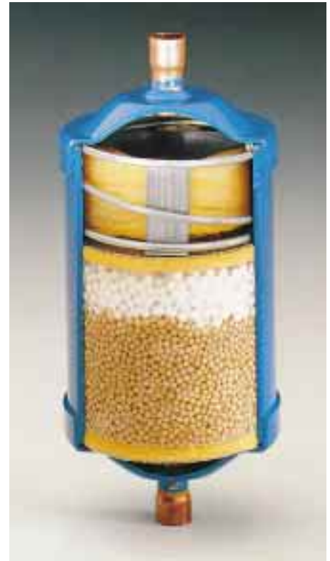
„WorldSeries“, ein Schnitt durch die neuen Flüssigkeits-Filtertrockner von KMP Kenmore. Die sinnvolle Konstruktion mit zusätzlichem Dispersionsfilter und Verteilerplatte erzielt eine Verdoppelung der Filtrations- und Feuchtigkeitsaufnahmekapazität.
