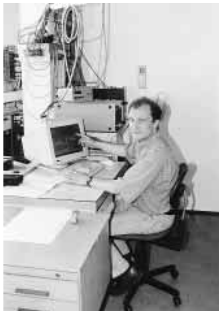
Versuchsstand zu Leistungsmessungen an Wärmeübertragern. Dieser ermöglicht Leistungsmessungen an Ventilator-Luftkühlern nach ENV 328 und DIN 8955 von 0,5 kW bis 25 kW Kälteleistung in Verbindung mit allen neuen Kältemitteln auf Fluor- und Kohlenwasserstoffbasis. Auf den Abbildungen Dr.-Ing. Michael Arnemann und Dipl.-Ing. Florian Wieschollek mit zusätzlichen Erläuterungen für die KK.
