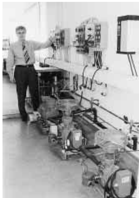
Versuchsstand zu Leistungsmessungen an Wärmeübertragern. Dieser ermöglicht Leistungsmessungen an Ventilator-Luftkühlern nach ENV 328 und DIN 8955 von 0,5 kW bis 25 kW Kälteleistung in Verbindung mit allen neuen Kältemitteln auf Fluor- und Kohlenwasserstoffbasis. Auf den Abbildungen Dr.-Ing. Michael Arnemann und Dipl.-Ing. Florian Wieschollek mit zusätzlichen Erläuterungen für die KK.
