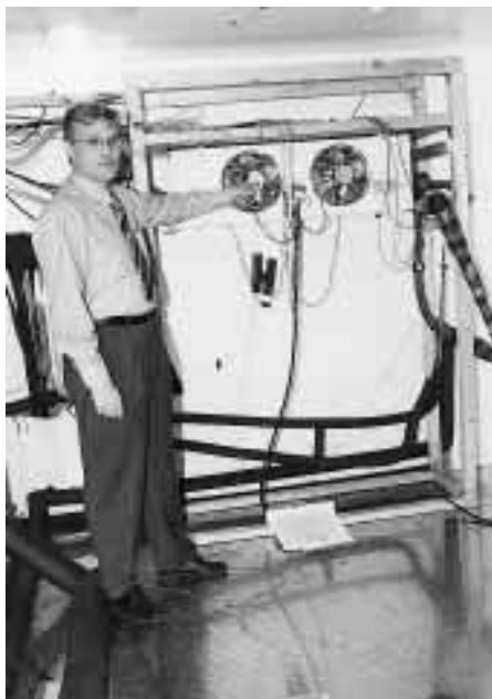
Versuchsstand zu Leistungsmessungen an Wärmeübertragern. Dieser ermöglicht Leistungsmessungen an Ventilator-Luftkühlern nach ENV 328 und DIN 8955 von 0,5 kW bis 25 kW Kälteleistung in Verbindung mit allen neuen Kältemitteln auf Fluor- und Kohlenwasserstoffbasis. Auf den Abbildungen Dr.-Ing. Michael Arnemann und Dipl.-Ing. Florian Wieschollek mit zusätzlichen Erläuterungen für die KK.
