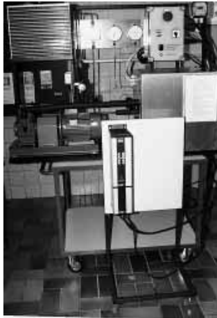
„Kälteanlagenbauer“ haben in Gelnhausen ihr eigenes Reich bzw. verfügen über eine sehr umfangreiche Laboreinrichtung für praktische Übungen. In der Mitte ein fahrbares Prüfmodul zur Erprobung der Leistungsregelung von Verdichtern.
