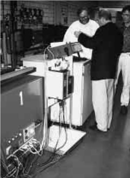
Für die Leistungs- und Drehzahlregulierung von Motorverdichtern gibt es sehr vielseitige Möglichkeiten, Dipl.-Ing. Claus Heyland erläutert hier in einer der Werkstätten der Bundesfachschule die Drehzahlregelung über Frequenzumformer in einer praktischen Vorführung.
