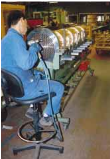
Im Werk Cremieux werden neben Lamellenverflüssigern kleinerer Leistungen für OEM-Erzeugnisse, Flüssigkeitsbehältern und Ölabscheidern vor allem Rohrbündelwärmetauscher gefertigt. Die linke Abbildung zeigt das Einwalzen der Kupferrohrendstücke, die rechte Abbildung die anschließende Druckprüfung vor der endgültigen Lackierung.
