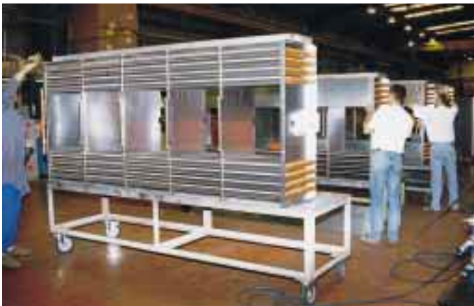
Verdampferfertigung im Werk Genas. Das linke Bild zeigt die Batterieanordnung in der Type GTI, ein beidseitig ausblasender Deckenverdampfer. Bei der rechten Abbildung handelt es sich um eine Verdampfersonderanfertigung.
