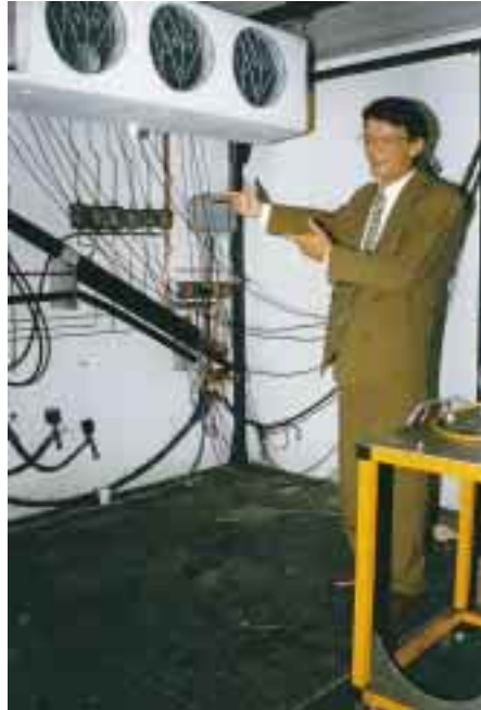
„Le Froid en Echange“, Wahlspruch von FRIGA-BOHN. Das bedeutet, Kälte ist im Wandel und ständige Forschung und Entwicklung sichern das Marktpotential. Eindrücke aus der Entwicklungsabteilung. Links eine Windkanalmeßeinrichtung, in der Mitte und rechts Kalorimeterräume mit Leistungsmessungen an Ventilatorluftkühlern.
