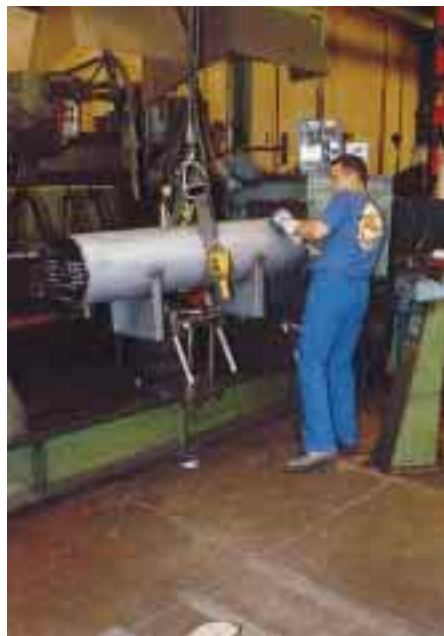
Im Werk Cremieux werden neben Lamellenverflüssigern kleinerer Leistungen für OEM-Erzeugnisse, Flüssigkeitsbehältern und Ölabscheidern vor allem Rohrbündelwärmetauscher gefertigt. Die linke Abbildung zeigt das Einwalzen der Kupferrohrendstücke, die rechte Abbildung die anschließende Druckprüfung vor der endgültigen Lackierung.
