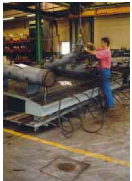
Im Werk Cremieux werden neben Lamellenverflüssigern kleinerer Leistungen für OEM-Erzeugnisse, Flüssigkeitsbehältern und Ölabscheidern vor allem Rohrbündelwärmetauscher gefertigt. Die linke Abbildung zeigt das Einwalzen der Kupferrohrendstücke, die rechte Abbildung die anschließende Druckprüfung vor der endgültigen Lackierung.
