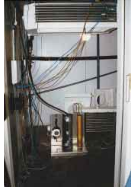
„Le Froid en Echange“, Wahlspruch von FRIGA-BOHN. Das bedeutet, Kälte ist im Wandel und ständige Forschung und Entwicklung sichern das Marktpotential. Eindrücke aus der Entwicklungsabteilung. Links eine Windkanalmeßeinrichtung, in der Mitte und rechts Kalorimeterräume mit Leistungsmessungen an Ventilatorluftkühlern.
