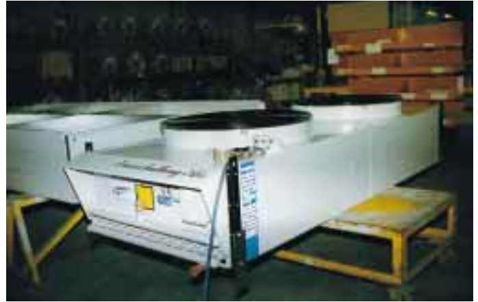
Ein Blick in die Fertigungshalle von Genas und auf die Eurochalleng'Airluftgekühlten Verflüssiger, bei denen die Hochleistungsbatterien aufgrund besonderer Konstruktionsmerkmale „schwimmend gelagert“ sind.
