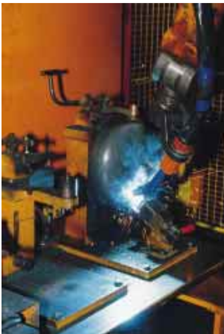
Gehäusefertigung für den Scroll. Automatische Schweißroboter verschweißen alle Anschlußstutzen mit dem Gehäuse.
