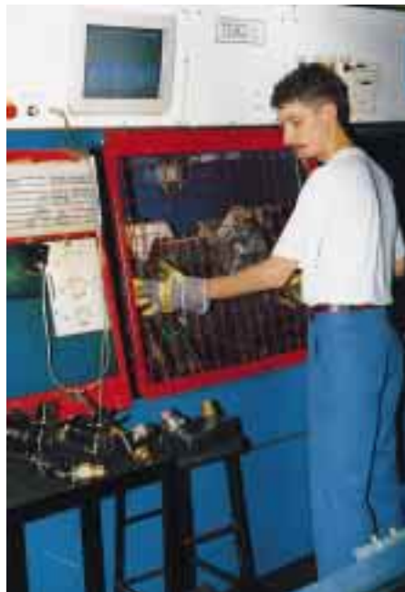
Kein Verdichter verläßt die Copeland-Fertigung in Welkenraedt, ehe er nicht auch einen abschließenden Funktions- und Leistungsprobelauf absolviert hat. „ACCEPTTE“ bedeutet „Freigabe“, die Anzeige ist elektronisch und damit unbestechlich.
