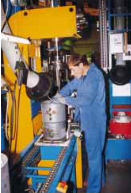
Einsetzen der Motorwicklungen für die gewünschten elektrischen Spannungen und Frequenzen, Deckel drauf, Dichtheitsprüfung, Öl- und Stickstofffüllung, Probelauf. Guy Küpper (mittlere Abbildung rechts), Copeland-Fertigungsleiter in Welkenraedt, erklärt hier einige Details.
