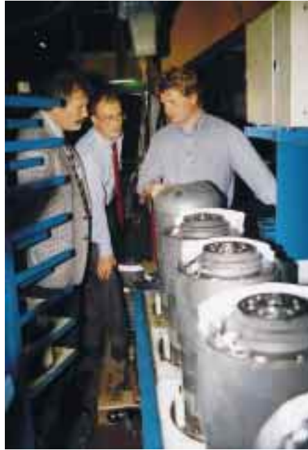
Einsetzen der Motorwicklungen für die gewünschten elektrischen Spannungen und Frequenzen, Deckel drauf, Dichtheitsprüfung, Öl- und Stickstofffüllung, Probelauf. Guy Küpper (mittlere Abbildung rechts), Copeland-Fertigungsleiter in Welkenraedt, erklärt hier einige Details.
