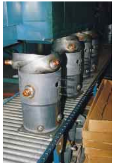
Gehäusefertigung für den Scroll. Automatische Schweißroboter verschweißen alle Anschlußstutzen mit dem Gehäuse.
