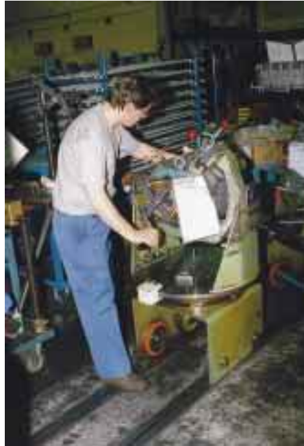
Eindrücke bzw. Fertigungsausschnitte beim Zusammenbau eines semihermetischen Hubkolbenverdichters größerer Leistung.
