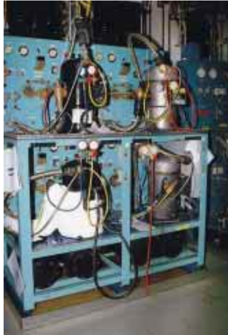
Es scrollt und scrollt in den Versuchslabors. Hier Dauerlauftests bis zur Zerreiß- pardon – Verreißprobe.
