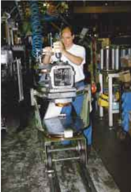
Eindrücke bzw. Fertigungsausschnitte beim Zusammenbau eines semihermetischen Hubkolbenverdichters größerer Leistung.
