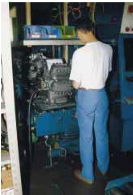
Kein Verdichter verläßt die Copeland-Fertigung in Welkenraedt, ehe er nicht auch einen abschließenden Funktions- und Leistungsprobelauf absolviert hat. „ACCEPTTE“ bedeutet „Freigabe“, die Anzeige ist elektronisch und damit unbestechlich.
