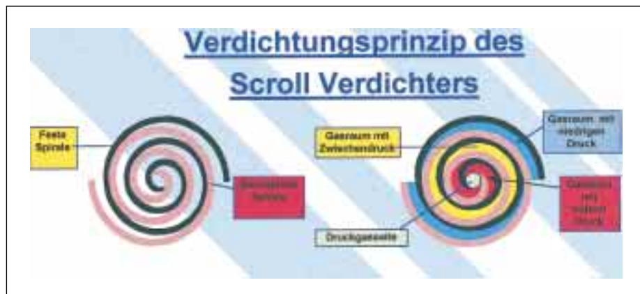
Das Verdrichtungsprinzip des Scroll-Verdichters. Umdrehungsgeschwindigkeit 2900 U/min, feste Spirale – bewegliche Spirale, gleichmäßiger, kontinuierlicher Verdichtungsprozeß. Keine Dichtungselemente notwendig, Spiralen dichten durch direkten Kontakt. Keine Schmierung zwischen den Spiralen.
