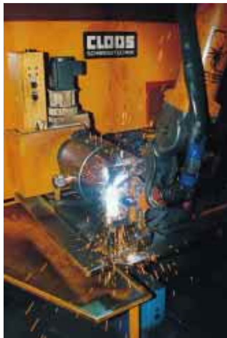
Gehäusefertigung für den Scroll. Automatische Schweißroboter verschweißen alle Anschlußstutzen mit dem Gehäuse.
