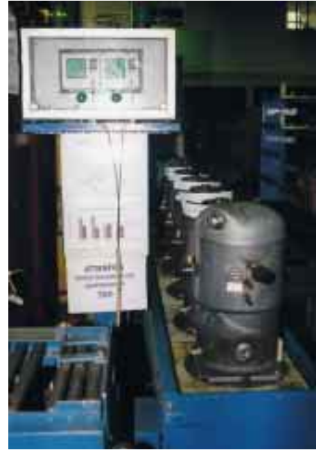
Einsetzen der Motorwicklungen für die gewünschten elektrischen Spannungen und Frequenzen, Deckel drauf, Dichtheitsprüfung, Öl- und Stickstofffüllung, Probelauf. Guy Küpper (mittlere Abbildung rechts), Copeland-Fertigungsleiter in Welkenraedt, erklärt hier einige Details.
