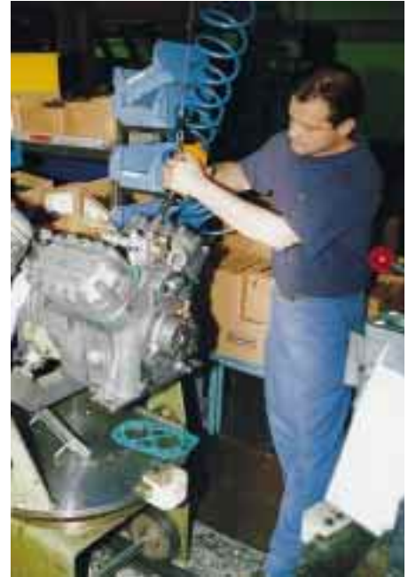
Eindrücke bzw. Fertigungsausschnitte beim Zusammenbau eines semihermetischen Hubkolbenverdichters größerer Leistung.
