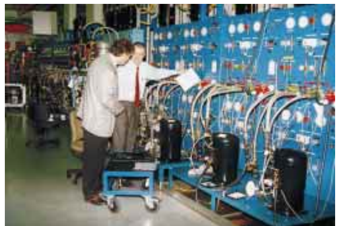
Copeland unterhält in Welkenraedt ein hochmodernes Technologiezentrum, das einzige in ganz Europa. Auf dem rechten Bild ein Eindruck über die 34 Dauersteststände, geeignet für alle Verdichterarten, auf der Abbildung links zertifiziert die Urkunde unter Glas, daß Welkenraedt berechtigt ist, als unabhängiges und autorisiertes Prüflabor UL (Underwriters Laboratories Inc.)-Tests nach vorgeschriebener Prüfmethode durchzuführen.
