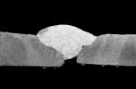
Abb. 2 Fehlerhafte Ausführung einer Schweißnaht. Die Mängelanalyse ergibt: Einbrandkerbe, Wurzelbindefehler, ungenügende Durchschweißung.
