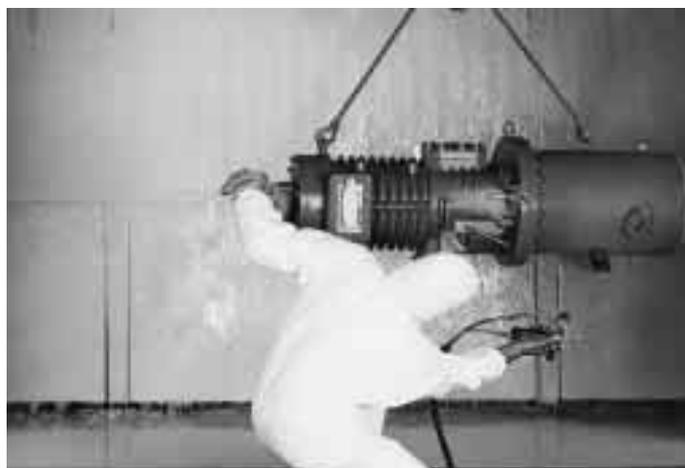
Lackieranlage auf Wasserlack-Basis: Lackierung aller Teile im Spritzverfahren. Die dahinterliegende Wasserwand bindet allen überschüssigen Lack und führt ihn dem Recycling-Kreislauf zu.
