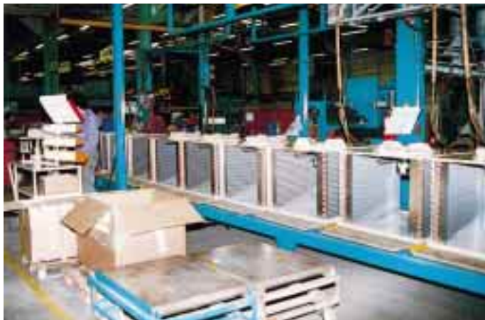
Der Produktionsablauf für die Klimageräte-Fertigung bei Airwell unterliegt Qualitätsanforderungen, wie sie ISO 9001 standardisiert. Die meisten Zubehörteile werden von Airwell selbst hergestellt. Zum Beispiel die Wärmetauscher für Verflüssigereinheit und Verdampferteil. Von der „Rolle“ bis zur betriebsfertigen Funktion. Innenberippte Kupferrohre erhöhen die Effizienz des Wärmeaustauschs und senken die Kosten für elektrische Energie.
