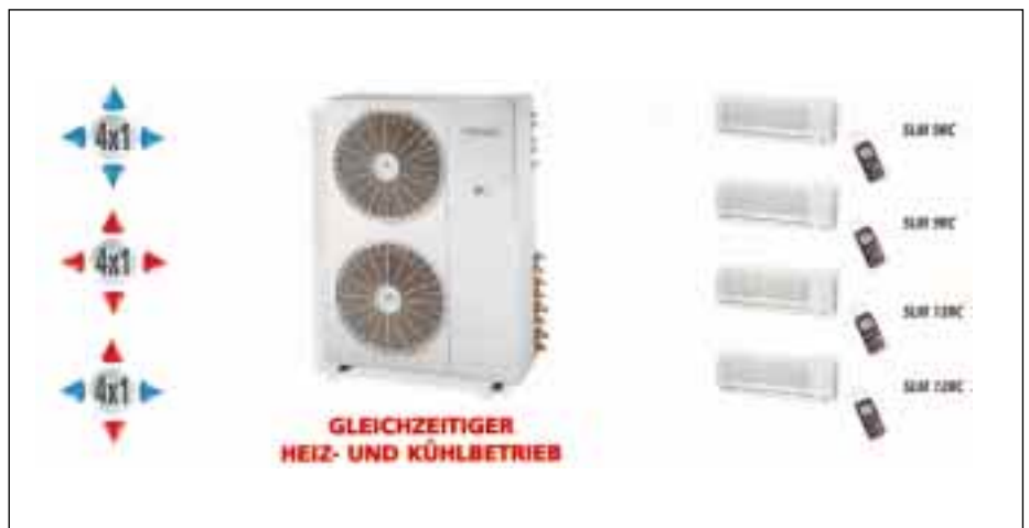
Auch dies gehört inzwischen zum Standard: Mit Multisplit kann man nicht nur kühlen, man darf auch heizen. „QUATTRO“ nennt sich das hier abgebildete Multi-Splitklimagerät mit 9260 W Kälteleistung. Es besteht aus einer Verflüssigereinheit mit schalldämmten Rollkolbenverdichtern und zwei Kältemittelkreisläufen. Die vier Inneneinheiten (auch mit zwei unterschiedlichen Leistungsgrößen) können jeweils über eine Infrarot-Fernbedienung individuell gesteuert werden. So läßt sich mit jedem Innenteil bei Bedarf individuell entweder heizen oder kühlen.
