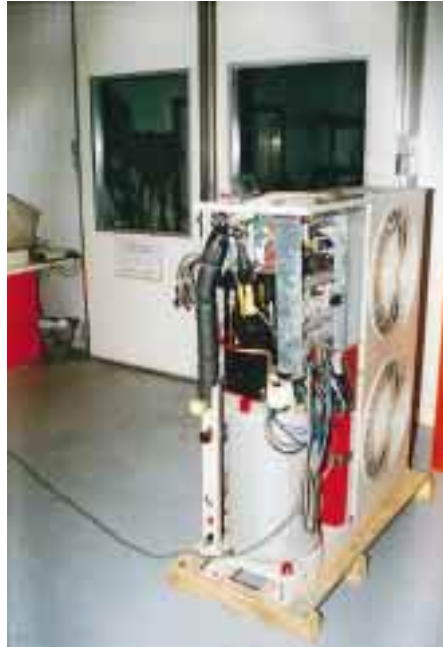
So oder so. Entweder dezentrale Verflüssigereinheiten für den Betrieb von Split-Klimasystemen oder eingebaute Verdichter in Klimazentralen, wie Verkaufsleiter Kundt hier zeigt. „Europäisch-französisch“ gekühlt wird vorläufig weiterhin mit dem Kältemittel R 22, R 407C wird erst mittelfristig genutzt. R 410 A kommt abhängig von der entsprechenden Komponenten-Verfügbarkeit erst später in Betracht, Kohlenwasserstoffe finden als Kältemittel auch in absehbarer Zukunft keine Verwendung.
