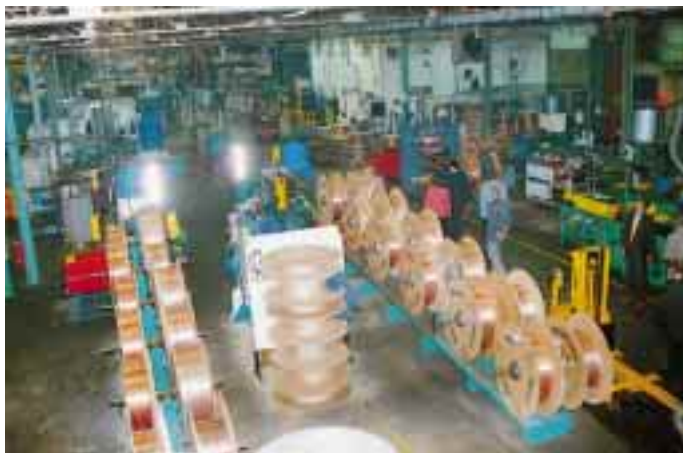
Der Produktionsablauf für die Klimageräte-Fertigung bei Airwell unterliegt Qualitätsanforderungen, wie sie ISO 9001 standardisiert. Die meisten Zubehörteile werden von Airwell selbst hergestellt. Zum Beispiel die Wärmetauscher für Verflüssigereinheit und Verdampferteil. Von der „Rolle“ bis zur betriebsfertigen Funktion. Innenberippte Kupferrohre erhöhen die Effizienz des Wärmeaustauschs und senken die Kosten für elektrische Energie.
