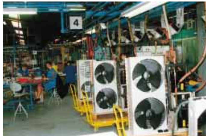
Der Produktionsablauf für die Klimageräte-Fertigung bei Airwell unterliegt Qualitätsanforderungen, wie sie ISO 9001 standardisiert. Die meisten Zubehörteile werden von Airwell selbst hergestellt. Zum Beispiel die Wärmetauscher für Verflüssigereinheit und Verdampferteil. Von der „Rolle“ bis zur betriebsfertigen Funktion. Innenberippte Kupferrohre erhöhen die Effizienz des Wärmeaustauschs und senken die Kosten für elektrische Energie.
