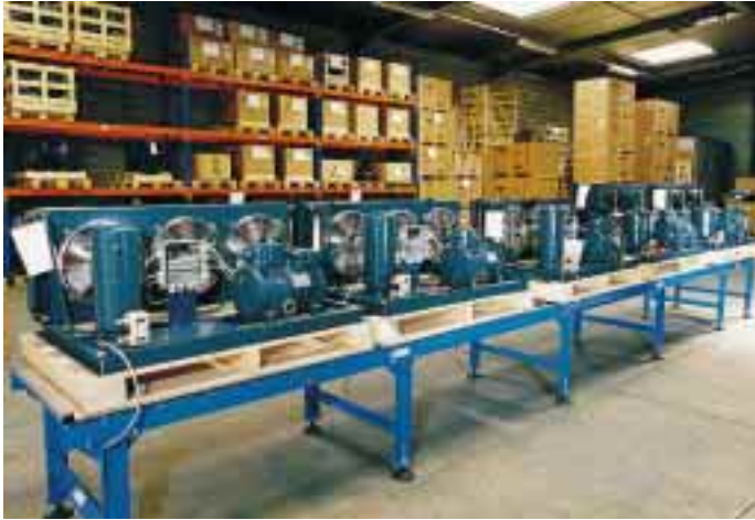
In Villedor werden DORIN-Verflüssigersätze auf Kundenwunsch umgerüstet und auf länderspezifische Anforderungen angepaßt.
