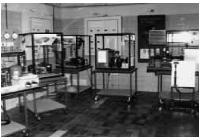
Das Herz des Kältelabors. Mehrere module Schulungsgeräte, die in Zusammenarbeit mit dem Transferzentrum für Kältetechnik an der Fachhochschule Karlsruhe von der Steinbeiß-Stiftung in Karlsruhe gebaut wurden, dienen dazu, die Auszubildenden im Kälteanlagenbauerhandwerk in die Lage zu versetzen, während handlungsorientierten Unterrichtseinheiten Messungen vorzunehmen und Meßprotokolle anzufertigen sowie die daraus resultierenden Erkenntnisse anschließend zu formulieren.
