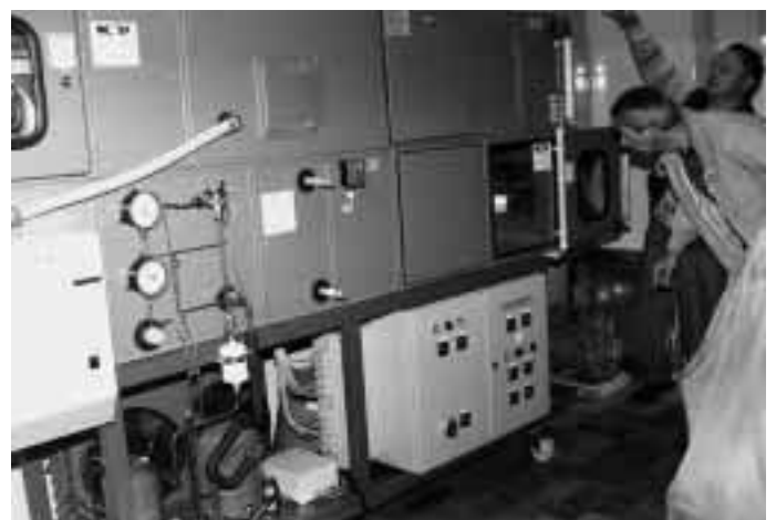
Die „Klimatechnik“ ist bereits seit 1991 mit einem eigenen Stundenkontingent innerhalb der Block-Unterrichtswoche berücksichtigt. Neu ist seit Frühjahr 1996 eine Modell-Klimaanlage, die zur Messung von Luftzuständen dem Schüler zur Verfügung steht. Neben einer Direktexpansions-Kälteanlage wird jetzt zusätzlich ein Kaltwassersatz mit dazugehörigem Wärmetauscher für den Parallelbetrieb integriert.
