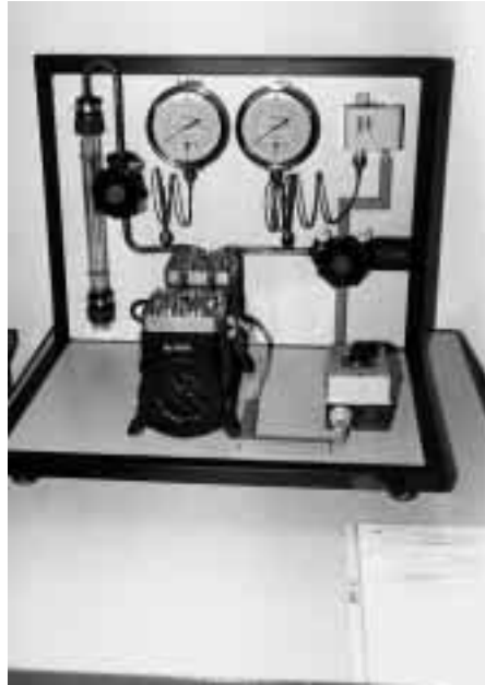
„Das besondere Etwas“ im Kältelabor der Berufsbildenden Schule Gelnhausen. Mit der hier abgebildeten Versuchsanordnung lassen sich durch den Berufsschüler sowohl Ansaugvolumenmessungen vornehmen als auch den Liefergrad eines Verdichters bestimmen. Das Besondere: mit Luft statt Kältemittel läßt sich das Lernziel ebenfalls erreichen.
