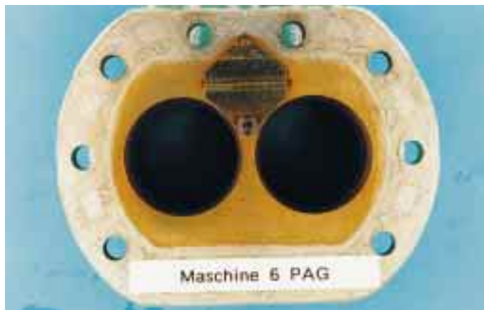
Abb. 3 Kupferplattierung an einem Verdichterbauteil.
