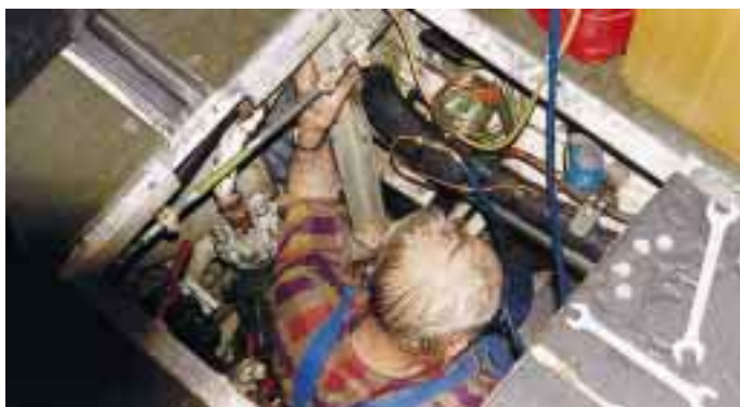
U 26 auf den Azoren: Hans-Hermann Schrot steigt in den „Keller“. Alles schön übersichtlich und zu erkennen auf den ersten Blick. Aber wie kann man da arbeiten? Schrot kann das. Zu lange Maulschlüssel werden zuvor „winkelförmig“ umgestaltet.
