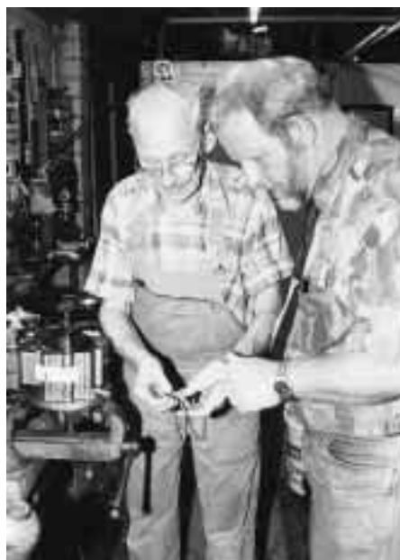
„Da haben wir das Problem“, erläutert Hans-Hermann Schrot gegenüber Dipl.-Ing. Heiko Sauer die Schadensursache. „O-Ringe vom Gehäuse-Verschlußdeckel undicht, aber auch die Flanschdichtungen.“ Ersatzteile von ROTOCOLD gibt es nicht mehr. Die Produktion dieses Flügelzellen-Verdichters (Kälteleistung 25,8 kW mit Kältemittel R 22 bei t_0 5 °C und t 30 °C, Antriebsleistung 5,2 kW, 1750 U/min) wurde beim englischen Hersteller eingestellt. Auch hierbei ist Schrot gefordert. Irgendwoher passende und Kältemittel/Öl-verträgliche O-Ringe besorgen, Flansch- und Ventildeckeldichtungen werden „wie früher“ von Schrot-Hand aus Oelit paßgenau hergestellt.
