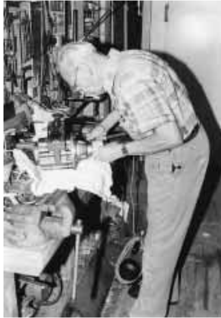
„Das können wieder nur die Dichtungen sein, die nach einiger Betriebszeit nicht mehr Kältemittel/Kälteöl-verträglich sind. Erst einmal wieder die Kupplung des Elektromotorantriebs abgezogen, um auch die „Innereien“ kritisch zu besichtigen, dann kommen Ventilplatte, Flanschanschlüsse und der Gehäusedeckel dran. Um keine Zeit zu verlieren, wird mit der anderen Hand schon mal telefoniert und wegen des weiteren Vorgehens Dipl.-Ing. Heiko Sauer, der TNSW-Objektleiter Marineschiffsreparaturen zum raschen „Vorbeischauen“ animiert.
