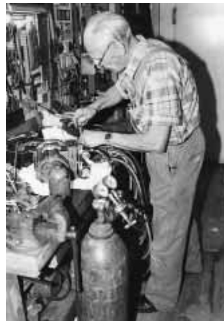
Wenn Hans-Hermann Schrot Glück hat, kommt der ROTOCOLD-Flügelzellen-Verdichter nach Riepe ins Haus. Erst einmal mit Stickstoff abdrücken, um eine etwaige Undichte im Wasserbad auszumachen. Dazu genügt Ehefrau Hildes Waschschißel und wie man hier sehr gut erkennen kann: es blubbert wie bei einer U-Boot-Tauchfahrt nach allen Seiten kräftig raus.
