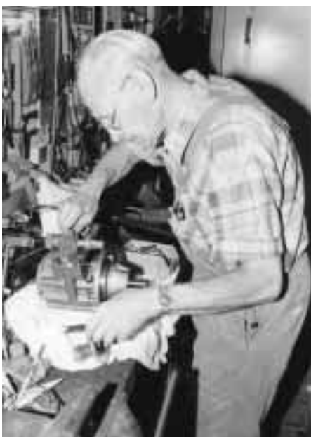
„Da haben wir das Problem“, erläutert Hans-Hermann Schrot gegenüber Dipl.-Ing. Heiko Sauer die Schadensursache. „O-Ringe vom Gehäuse-Verschlußdeckel undicht, aber auch die Flanschdichtungen.“ Ersatzteile von ROTOCOLD gibt es nicht mehr. Die Produktion dieses Flügelzellen-Verdichters (Kälteleistung 25,8 kW mit Kältemittel R 22 bei t_0 5 °C und t 30 °C, Antriebsleistung 5,2 kW, 1750 U/min) wurde beim englischen Hersteller eingestellt. Auch hierbei ist Schrot gefordert. Irgendwoher passende und Kältemittel/Öl-verträgliche O-Ringe besorgen, Flansch- und Ventildeckeldichtungen werden „wie früher“ von Schrot-Hand aus Oelit paßgenau hergestellt.
