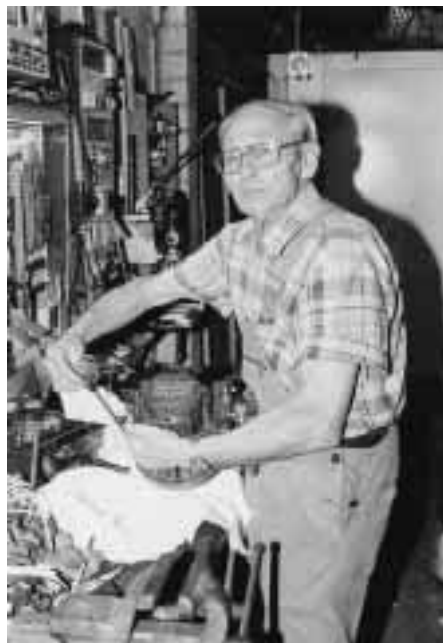
Wenn Hans-Hermann Schrot Glück hat, kommt der ROTOCOLD-Flügelzellen-Verdichter nach Riepe ins Haus. Erst einmal mit Stickstoff abdrücken, um eine etwaige Undichte im Wasserbad auszumachen. Dazu genügt Ehefrau Hildes Waschschißel und wie man hier sehr gut erkennen kann: es blubbert wie bei einer U-Boot-Tauchfahrt nach allen Seiten kräftig raus.
