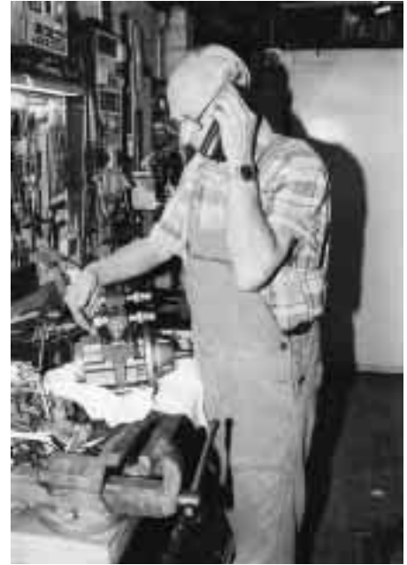
„Das können wieder nur die Dichtungen sein, die nach einiger Betriebszeit nicht mehr Kältemittel/Kälteöl-verträglich sind. Erst einmal wieder die Kupplung des Elektromotorantriebs abgezogen, um auch die „Innereien“ kritisch zu besichtigen, dann kommen Ventilplatte, Flanschanschlüsse und der Gehäusedeckel dran. Um keine Zeit zu verlieren, wird mit der anderen Hand schon mal telefoniert und wegen des weiteren Vorgehens Dipl.-Ing. Heiko Sauer, der TNSW-Objektleiter Marineschiffsreparaturen zum raschen „Vorbeischauen“ animiert.
