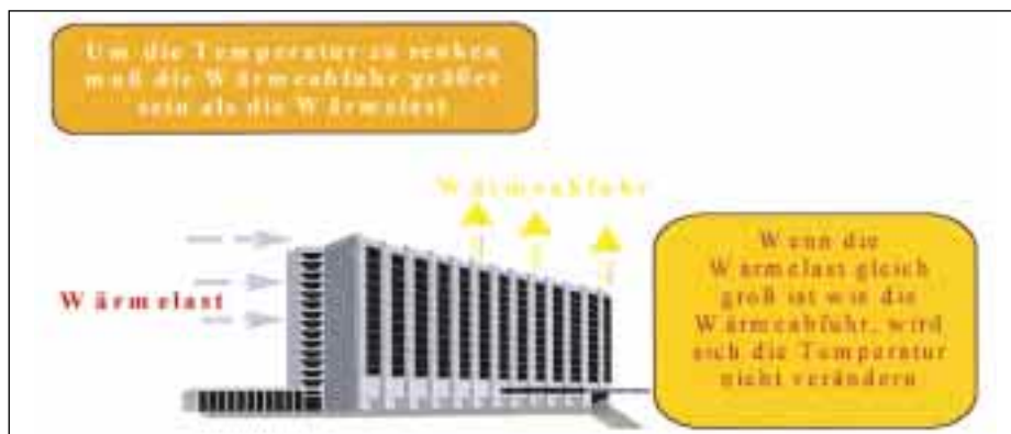
Abb. 1 Bildliche Darstellung der wesentlichen Kriterien, die bei einer Temperaturregelung zu berücksichtigen sind.
