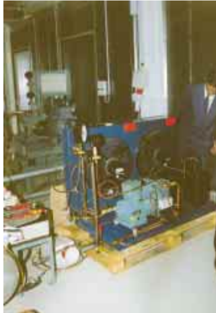
Ohne Entwicklung und Dauerlauf-Erprobung läuft nichts. Auf den Bitzer-Standort Schkeuditz wurde die Hubkolbenverdichter-Entwicklungsabteilung konzentriert. Die Abbildung rechts oben zeigt eine Versuchsanordnung des neuen kompakten Zweizylinders (auch für R 410A geeignet), die große Abbildung zeigt Dauerlauftests der Kompakten mit dem Kältemittel R 404A.
