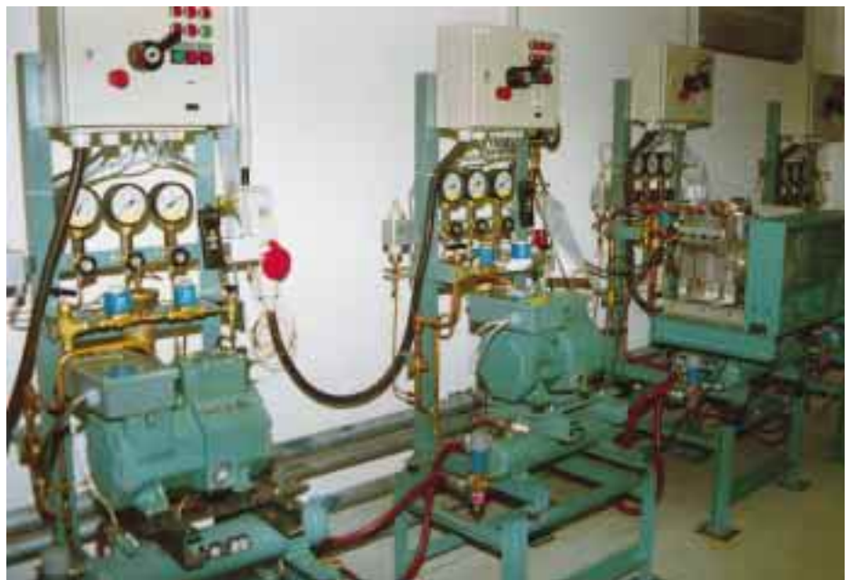
Ohne Entwicklung und Dauerlauf-Erprobung läuft nichts. Auf den Bitzer-Standort Schkeuditz wurde die Hubkolbenverdichter-Entwicklungsabteilung konzentriert. Die Abbildung rechts oben zeigt eine Versuchsanordnung des neuen kompakten Zweizylinders (auch für R 410A geeignet), die große Abbildung zeigt Dauerlauftests der Kompakten mit dem Kältemittel R 404A.
