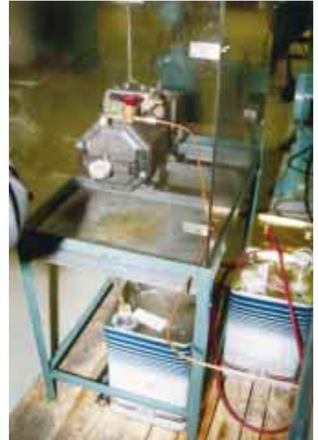
Ohne Entwicklung und Dauerlauf-Erprobung läuft nichts. Auf den Bitzer-Standort Schkeuditz wurde die Hubkolbenverdichter-Entwicklungsabteilung konzentriert. Die Abbildung rechts oben zeigt eine Versuchsanordnung des neuen kompakten Zweizylinders (auch für R 410A geeignet), die große Abbildung zeigt Dauerlauftests der Kompakten mit dem Kältemittel R 404A.
