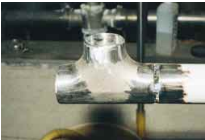
Das A und O bei den zu treffenden Sicherheitsvorkehrungen sind die geröntgten Schweißnähte an absolut korrosionsfrei verlegten Rohrleitungen. Die Abbildungen zeigen hierzu einige Details. Auf der Abbildung links oben ist der Anschluß zur Vorbereitung der Schweißnähte zu sehen. Die Abbildung rechts oben zeigt eine spezielle Kälteschelle. Nach Verlegung erhalten die Rohrleitungen einen 3fachen Spezial-Anstrich (Abb. links unten). Eine gut ausgeführte Isolierung der Rohrleitungen mit Blechmantel (Abb. unten rechts) verhindert eine Korrosion durch Einwirkung von Feuchtigkeit bzw. Schwitzwasser.
