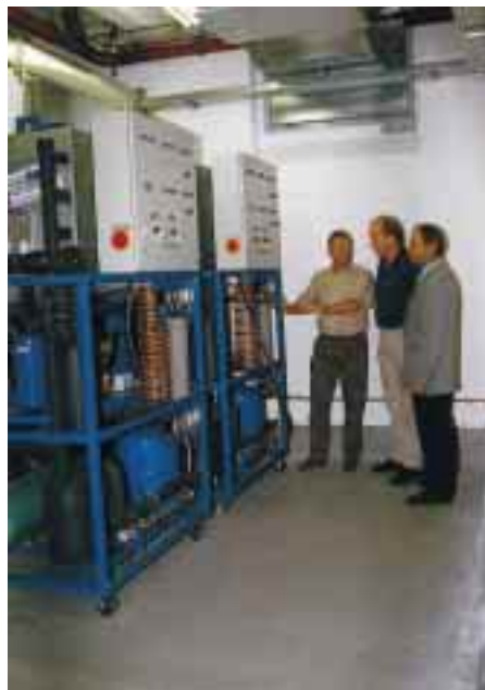
So geht's richtig. Die komplette 2stufige Tiefkühl-Kälteanlage ist auf einem fahrbaren Chassis anschlussfertig montiert und wird von außen hinten an die Tiefkühlzelle heran- und der Ventilatorluftkühler durch die Isolarelemente hineingeschoben. Abdichtung perfekt, keine Schwitzwasserbildung, Innentemperatur im Betrieb -80\text{ }^{\circ}\text{C} .
