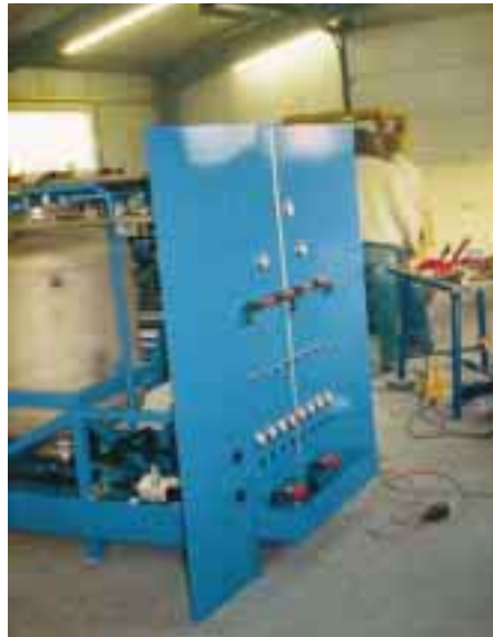
Ein Blick in die Werkstatt von K.S.R. und die hocheffizienten Absauganlagen. Rechts wird R 502 auf Transport- oder Zwischenlagerbehälter umgefüllt, links ist ein wenig „Innenleben“ einer mobilen Ammoniak-Abfüllstation mit Neutralisationsbehälter zu sehen.
