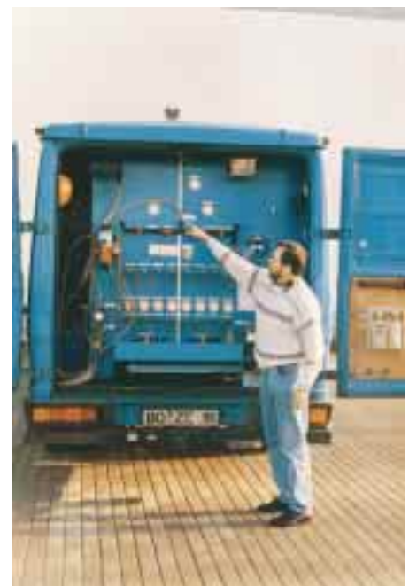
Mobile NH 3 -Absaug- und Neutralisationsstation, das linke Bild zeigt die Lager- und Transport-Container für die umweltneutrale Entsorgung.
