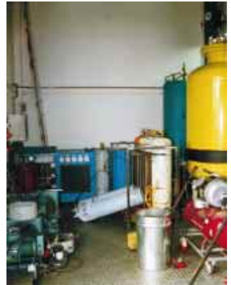
Ein Blick in die Werkstatt von K.S.R. und die hocheffizienten Absauganlagen. Rechts wird R 502 auf Transport- oder Zwischenlagerbehälter umgefüllt, links ist ein wenig „Innenleben“ einer mobilen Ammoniak-Abfüllstation mit Neutralisationsbehälter zu sehen.
