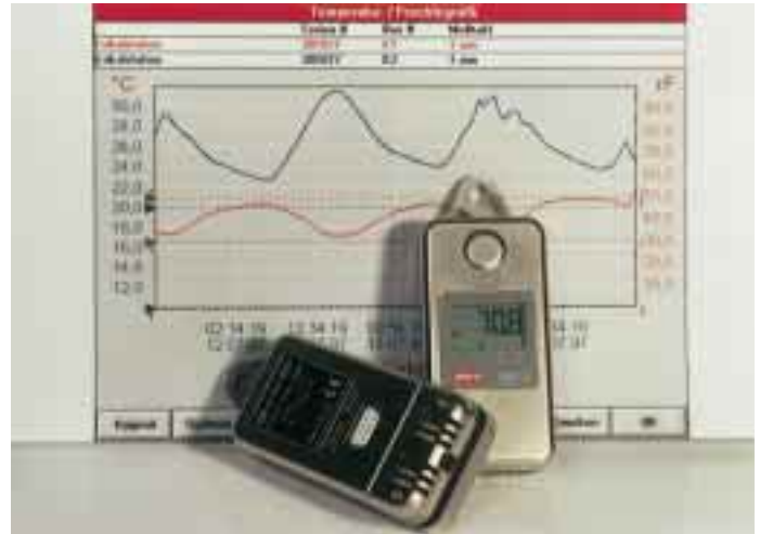
Kombinierter Feuchte-/Temperaturlogger EBI-2-TH.
