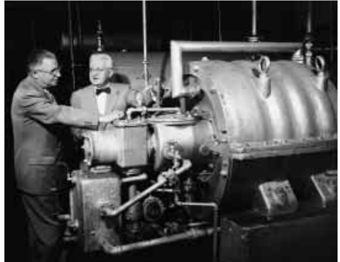
Abb. 1 Die erste von Dr. W. H. Carrier entwickelte Turbo-Kältemaschine wird vom Konstrukteur Adolph Zulinke (links) und Logan L. Lewis – einem der sieben Firmengründer der Carrier Corporation – nach einer störungsfreien Laufzeit von 36 Jahren inspiziert, bevor sie demontiert und zur Ausstellung in die Carrier-Hauptverwaltung nach Syracuse transportiert wird (alle Fotos Carrier).
