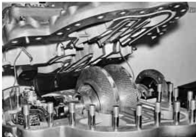
Abb. 3 Zweistufiger Turbokälteverdichter vor dem Zusammenbau. Auf dem Foto sind die Laufräder und Leitapparate besonders deutlich zu erkennen.
