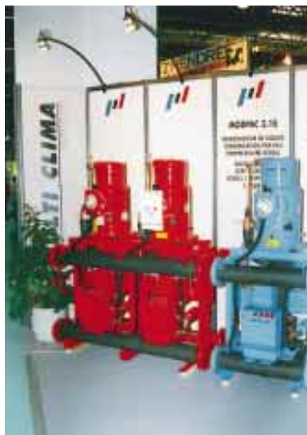
Wassergekühlte Flüssigkeitskühler mit Scrollverdichtern kann man schon von weitem an ihrem jeweiligen Einsatzzweck erkennen. „Blau“ kennzeichnet als Zweckbestimmung den Kühleinsatz, „rot“ den Wärmepumpenbetrieb. GEA-GRASSO zeigte mit der Baureihe RC12E seine neue Generation von Hubkolbenverdichtern, Copeland eine „Nouveau“ Generation von Scrolls aus Wellenraedert im Antriebsbereich von 7,5 PS und 10 PS.
