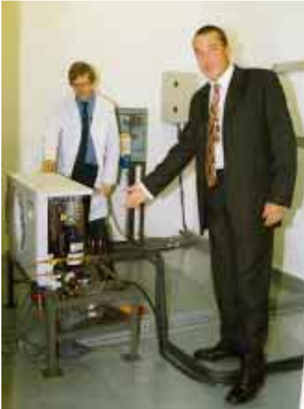
Gary King, verantwortlicher Manager für die Kundenbetreuung, und Test-Ingenieur Harry Wardman befinden sich in Testkammer 1 (oben links), in der Klimageräte im Kühl- und Wärmepumpenbetrieb bis zu 20 kW Kühlleistung nach allen internationalen Vorschriften getestet werden können. Hier der „Außenraum“ mit Temperaturspreizungen im Bereich von -5^{\circ}\text{C} und 55^{\circ}\text{C} . Die mittlere Abbildung zeigt den „Innenraum“ von Testkammer 1, in dem ein Deckenkassetten-Gerät im Eurorastermaß auf seine Funktionen getestet wird. Die rechte Abbildung schließlich zeigt einen Blick in den Versorgungsraum unterhalb der Testkammern, der alle mechanischen und elektrischen Versorgungseinheiten für das Testzentrum beinhaltet.
