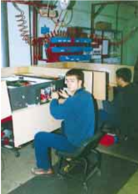
Das menschliche Arbeitskraftpotential der Mitarbeiter wird durch das Management laufend gefördert, Total Quality Workshops tragen dazu bei, daß optimal gefertigte Produkte die Werksbänder verlassen. Die Abbildung links oben zeigt das elektrische Verdrahten einer Klima-Deckenkassette, die sich während des gesamten Fertigungsablaufs schon im späteren Versandkarton befindet. Oben rechts und unten links sind Fertigungsschritte bei der Produktion von Verflüssigereinheiten zu sehen, Anthony Cole zeigt dann das auch optisch ansprechende fertige Produkt. Auf der Abbildung unten rechts ist die fertige Verdichter-Installation eines Kaltwassersatzes der Baureihe KKC 7 (Nennkälteleistung 22 kW) mit eingebauter Pumpe, Wasserausdehnungsgefäß und Mikroprozessorregelung zu sehen.
