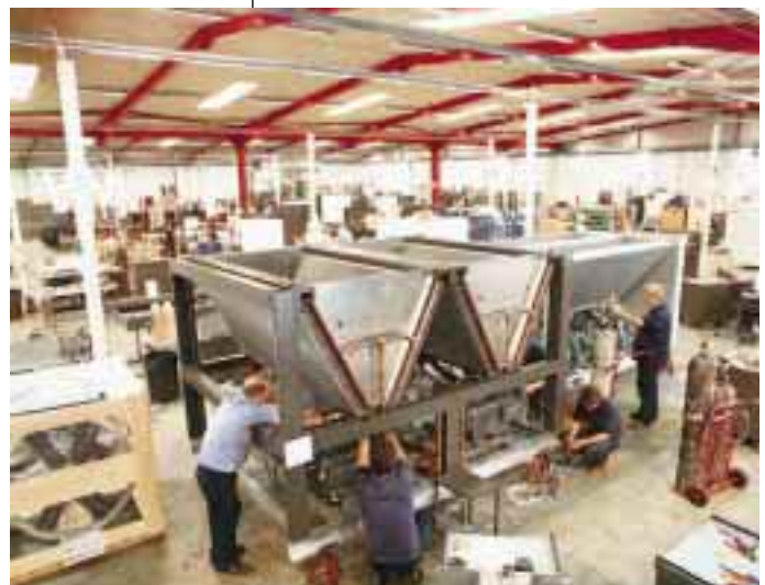
Ein Blick in die Fertigungshalle bei der Endmontage von luftgekühlten Kaltwassersätzen der Baureihe ACC. Kühlleistung zwischen 274 und 1016 kW.
