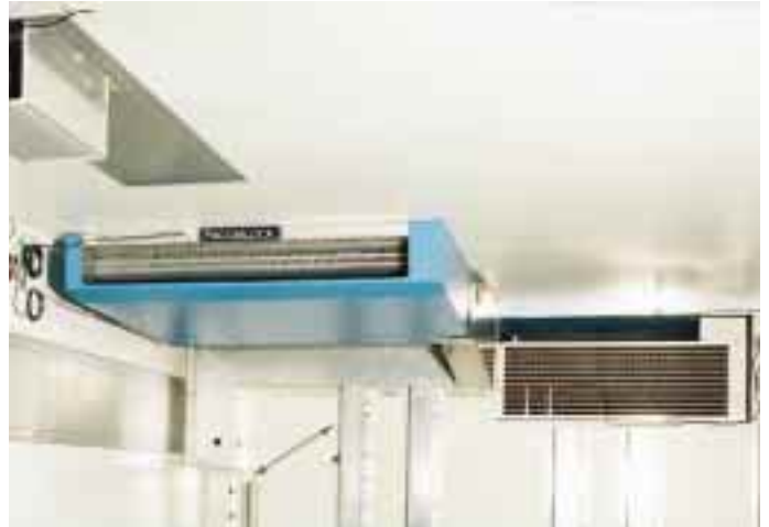
FRIGOBLOCK testet als erster Hersteller das umweltgerechte Ersatzkältemittel Propan, das bei minimalem Energieverbrauch eine hohe Kälteleistung bis -35\text{ }^{\circ}\text{C} Aufbauatemperatur ermöglicht. Damit stellt FRIGOBLOCK die erste Transportkälteanlage vor, deren Kältemittel weder eine Schädigung der Ozonschicht verursacht noch einen Beitrag zum Treibhauseffekt leistet.
