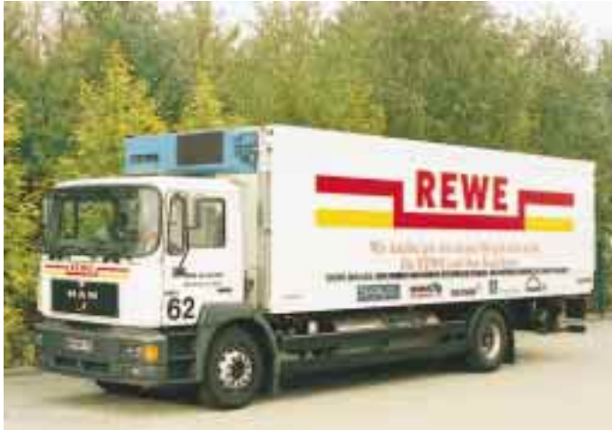
Der mit flüssigem Methan angetriebene MAN-Frischdienst-Verteiler-Lkw der Firma REWE soll ca. 25 bis 30 % der benötigten Kälteenergie „kostenlos“ durch Verdampfung des tiefkalten Methangases ( -161\text{ }^{\circ}\text{C} ) erzeugen. Deshalb wurde zusätzlich neben dem generatorbetriebenen Standard-FRIGOBLOCK FK 13 mit außerhalb des Laderaums liegendem Verdampfer (rechts) ein von Messer Griesheim modifizierter FRIGOBLOCK-Flachverdampfer (links) für die Verdampfung des Lkw-Motor-Treibstoffes eingebaut.
