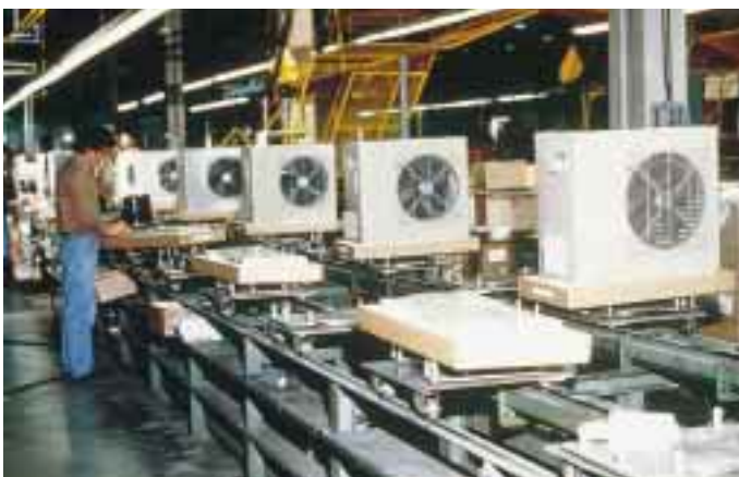
Ein Blick in die Fertigung der Produktionsstätte Villasanta. Hier das Fertigungsband für Verflüssigereinheiten der Typenreihe 38 GL, die ab März 1998 überwiegend mit dem Kältemittel R 410A ausgeliefert werden.
