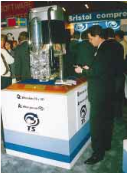
Der Messehit bei Bristol: der TS-Kompressor mit 2 Laufrichtungen. Besonders geeignet für Wärmepumpen. Vorwärts drehend mit 2 Hubkolben (100% Leistung), rückwärtsdrehend mit nur 1 Kolben im Betrieb (je nachdem 40 %, 50 % oder 60 %)
