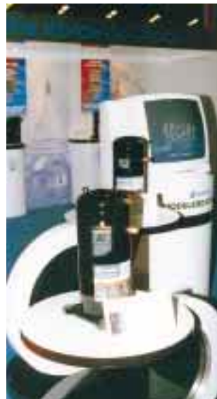
Modulated Scroll von Copeland. Leistungsregelung über Saugkammernbypass. 100 % oder 60 % Kälteleistung
