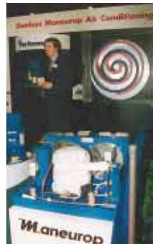
Die „Blauen“ von Danfoss Maneurop. Die Performer-Technologie macht's möglich, es gibt jetzt Duo-, Trio- und Quatro-Verdichtersätze zur Abdeckung größerer Kälteleistungen (siehe auch KK 2/98)
