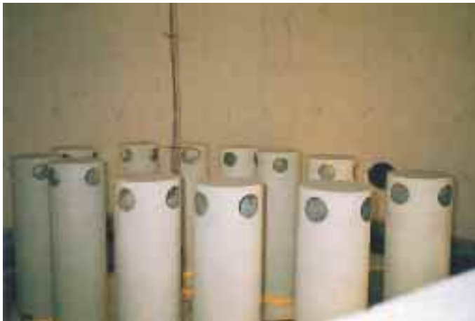
Abb. 8a Kühllastsimulatoren nach DIN 4715
