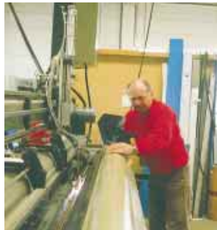
Ein spezielles automatisches Blechschweißverfahren macht es möglich, Bleche bis zu 3,20 Meter Länge oder Breite optisch kaum sichtbar zu einer Blechtafel zusammenschweißen. Dies ermöglicht z. B. die Fertigung fugenloser großflächiger Schiebetüren
