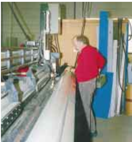
Ein spezielles automatisches Blechschweißverfahren macht es möglich, Bleche bis zu 3,20 Meter Länge oder Breite optisch kaum sichtbar zu einer Blechtafel zusammenschweißen. Dies ermöglicht z. B. die Fertigung fugenloser großflächiger Schiebetüren
