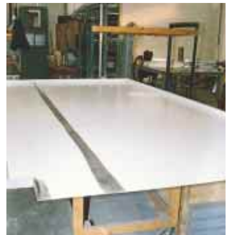
Ein spezielles automatisches Blechschweißverfahren macht es möglich, Bleche bis zu 3,20 Meter Länge oder Breite optisch kaum sichtbar zu einer Blechtafel zusammenschweißen. Dies ermöglicht z. B. die Fertigung fugenloser großflächiger Schiebetüren
