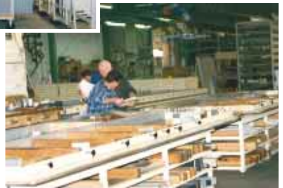
Mehrere PUR-Schäumvorrichtungen mit derzeit R 141b als Blähmittel stehen für die Herstellung unterschiedlich langer Isolier-elemente bereit. . . .
