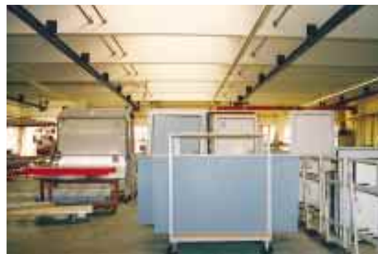
Mehrere PUR-Schäumvorrichtungen mit derzeit R 141b als Blähmittel stehen für die Herstellung unterschiedlich langer Isolier-elemente bereit. . . .
