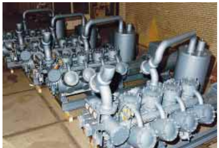
Vier RCU 1212 Hubkolbenverdichteraggregate mit mehr als 2 Megawatt Kälteleistung für die Eisbahn in Sarajevo, sind jetzt fertig und warten auf den Versand
