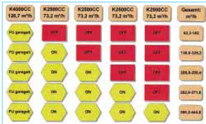
Abb. 2 a Mögliche Schaltungsvarianten beim Normalkühlverbund
