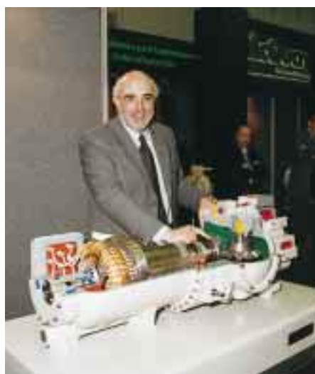
Star-Gate-Schraubenverdichter von McQuay. Luca Paoletta geht davon aus, daß sich R 410A als Kältemittel für Schraubenverdichter durchsetzen wird
