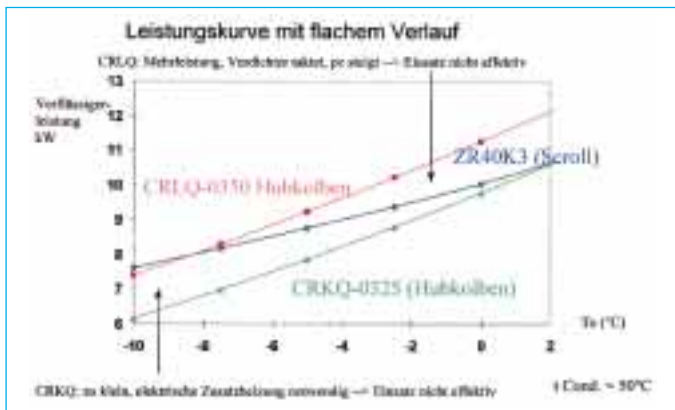
Abb. 7 Leistungskurvenvergleich Hubkolben- und Scrollverdichter im Wärmepumpeneinsatz
