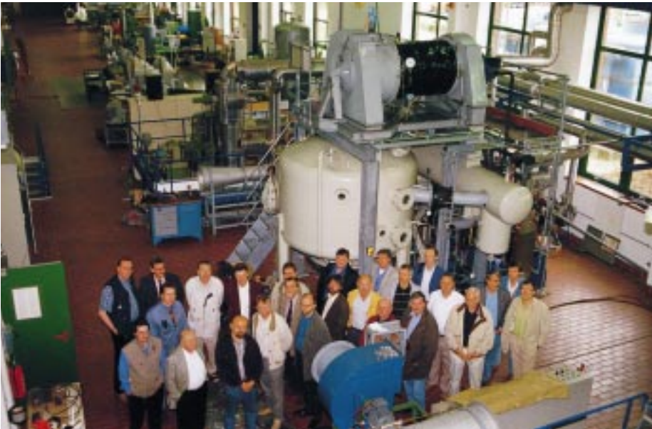
Der Hit des BIV-Lehrertreffens 1998: die Vakuum-Eis-Erzeugungsanlage, bei der Wasser als Kältemittel eingesetzt wird, im Großlabor von Integral am Standort Fachhochschule Flensburg. Obendrauf die hochtourige Turbine
