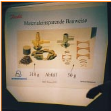
Welche materialsparende Vorzüge das neue TU-Ventil hat, ist aus den hier abfotografierten Folien zu entnehmen
