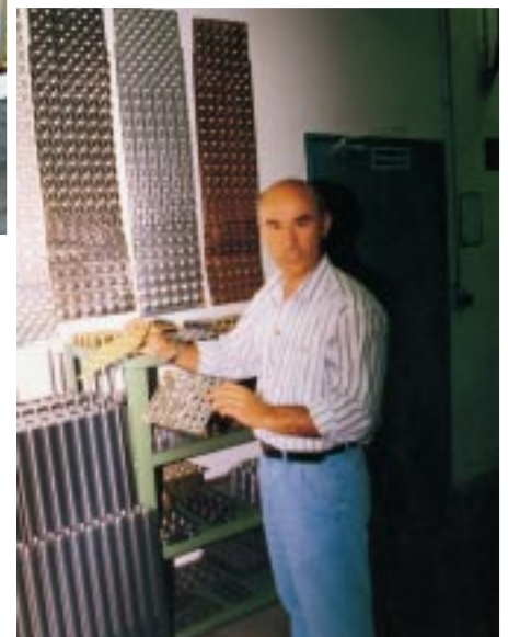
... Jürgen Piechowski (Vorentwicklung neue Serien + Sonderbau) demonstriert dies auf der rechten Abbildung, auf der linken Abbildung wird ein epoxidharzbeschichtetes Lamellenpaket eines luftbeaufschlagten Verflüssigers gezeigt
