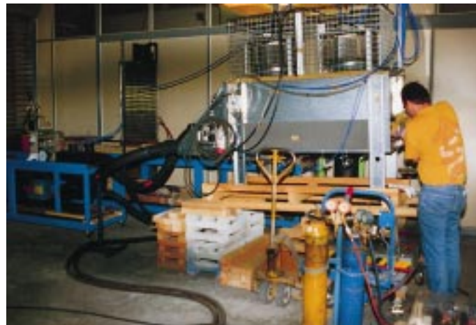
Ölkühler-Versuchsstand. Hier werden gerade Turbulatoren in die Rohrreihen des Prüflings eingeführt
