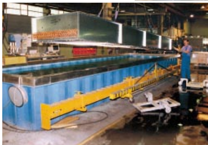
Alles in Bewegung. Dies zeigt ein Ausschnitt aus der Fertigungshalle und das Absenken eines Verflüssigerpaketes zur Dichtheitsprüfung in ein überdimensionales Tauchbecken
