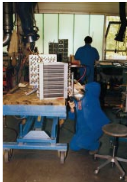
10 Lehrlinge werden im Maschinenbau und als Werkzeugmacher bei Guntner ausgebildet. Der Ausbilder prüft den Werkzeugschliff, auf der anderen Abbildung wird ein Sammelrohr am Spezialverdampfer angelötet
