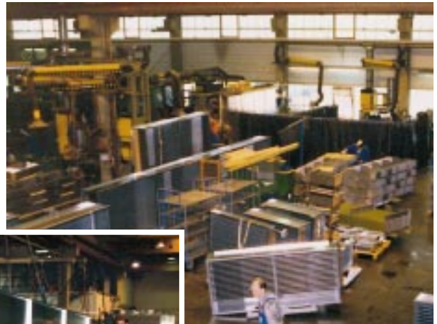
Alles in Bewegung. Dies zeigt ein Ausschnitt aus der Fertigungshalle und das Absenken eines Verflüssigerpaketes zur Dichtheitsprüfung in ein überdimensionales Tauchbecken
