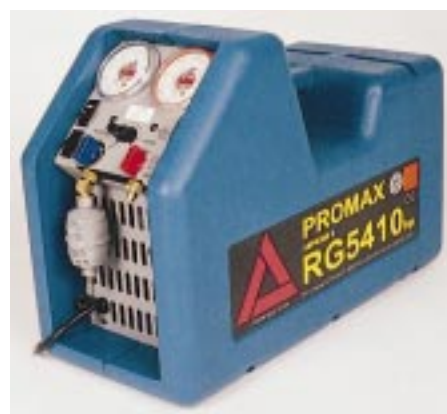
PROMAX RG 5410 ist ein Hochdruck-Entsorgungsgerät ölfrei von AMPROBE, das speziell für das Kältemittel R 410A und für einen Absaugdruck bis 38 bar entwickelt wurde
