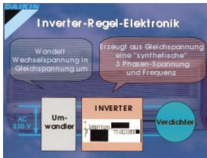
Der Technologiesprung bei DAIKIN. Inverterregelung bis hinunter zur kleinsten Klima-Spliteinheit mit Wärmepumpenschaltung. Wie dies bei einem Swing-Verdichter und 230 Volt elektrischem Geräteanschluß möglich wird, das veranschaulichen hier die beiden Abbildungen
