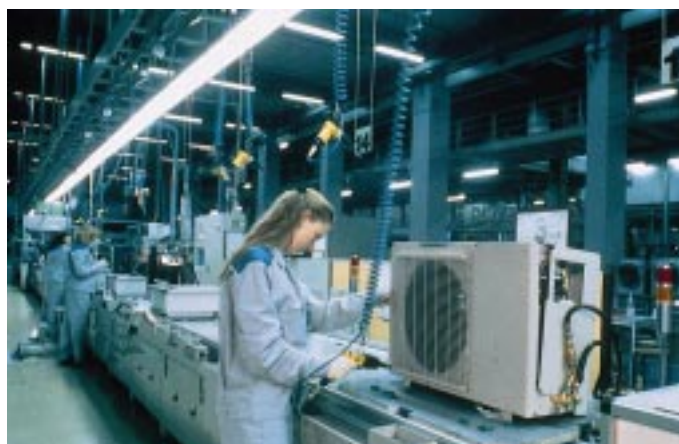
Ein Blick in die Fertigung Inverter-geregelter Außen-einheiten für Split- und Multisplit-Klimasysteme
