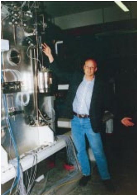
Abb. 11 Gefriertrocknung, geeignet für Sonderanwendungen. Dieckmann: „Für Anwendungen in der Pharmazie, wo es auf absolute Sterilität ankommt, ist der Steril-Belüftungsfilter eine sehr wichtige Komponente der Anlage!“
