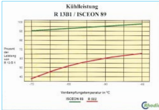
Abb. 7 Vergleich der Kälteleistung von ISCEON 89 mit R 13B1 (100 %) und R 502
