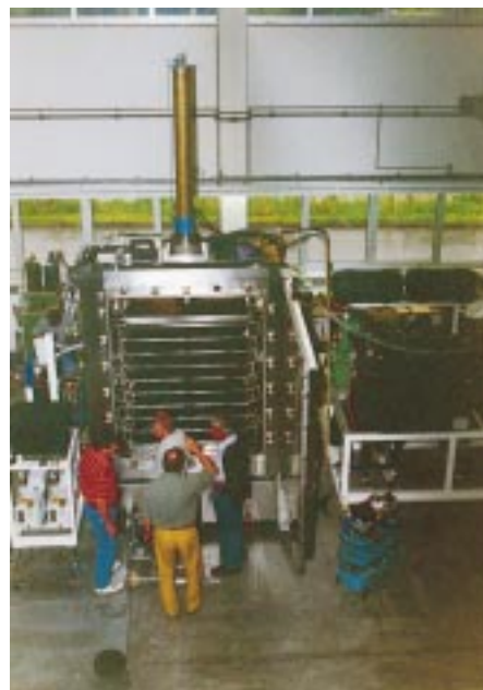
Abb. 10 Hydraulik von oben. Hierdurch ist eine Verdoppelung der Stellflächenabstände (9 Stück) möglich. Die Beschickung erfolgt 1etagig durch die sogenannte „Pizzatür“, siehe rechte Abbildung und Tabelle 1
