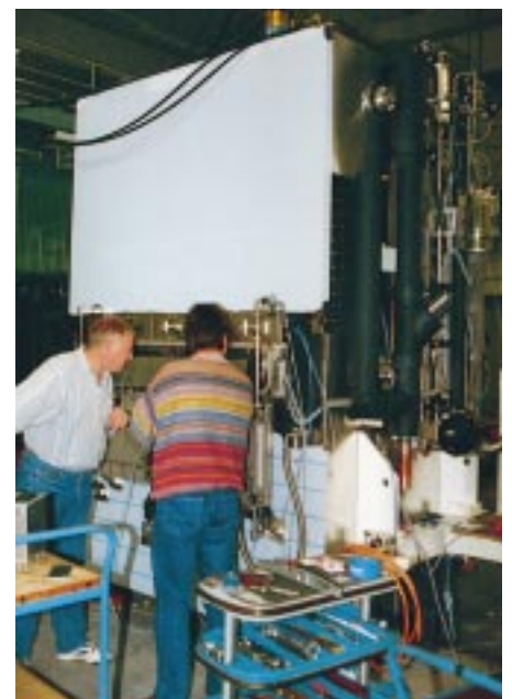
Abb. 10 Hydraulik von oben. Hierdurch ist eine Verdoppelung der Stellflächenabstände (9 Stück) möglich. Die Beschickung erfolgt 1etagig durch die sogenannte „Pizzatür“, siehe rechte Abbildung und Tabelle 1
