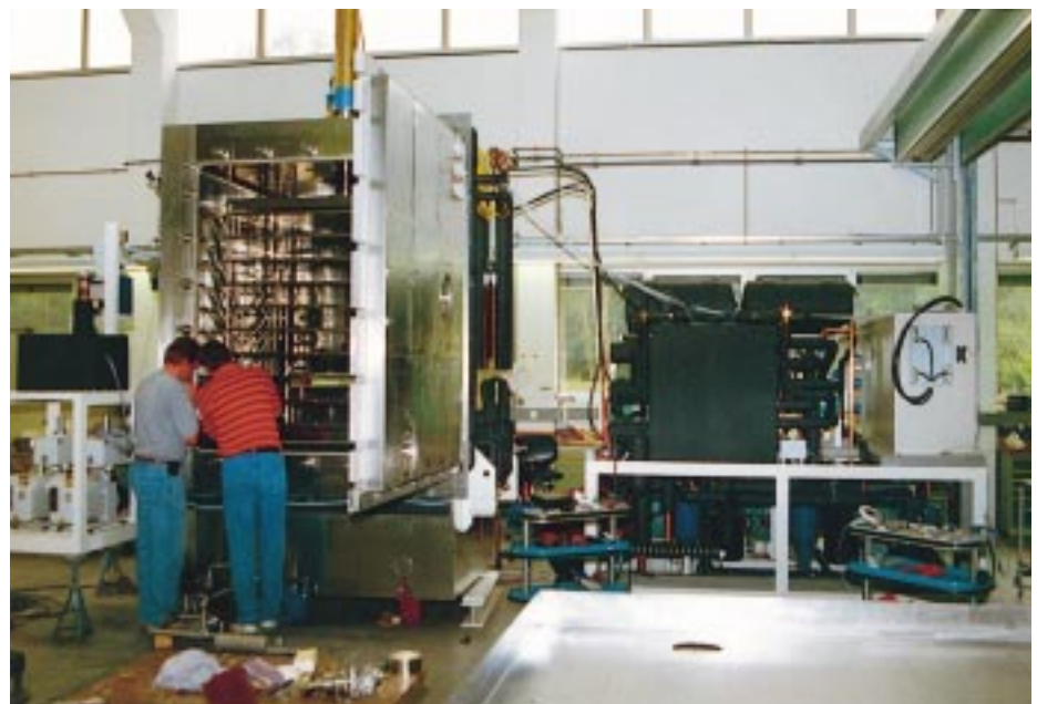
Abb. 8 CHRIST-Zweikammersystem Typ EPSILON 220DS spezial (siehe Tab. 1) mit separater Kältemaschineneinheit in Blockbauweise kurz vor der Fertigstellung und Auslieferung. Eiskondensatorkapazität 120 kg bis 220 kg/24 h
