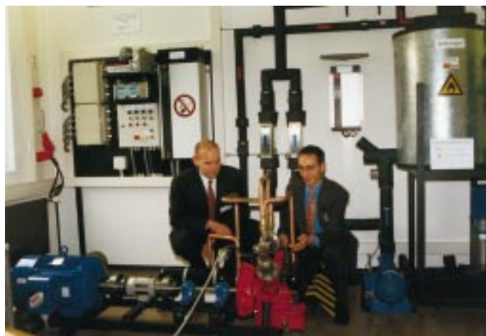
Aktuelle Forschungsarbeit „Auslegung und experimentelle Untersuchung einer Stirling-Kältemaschine für die Tiefkühlung in Supermärkten“. Hier mit den wissenschaftlichen Mitarbeitern André Siegel (links) und Holger Schikora (rechts)
