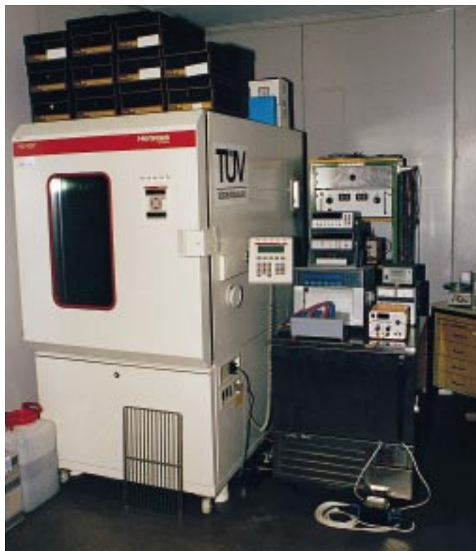
Abb. 3 Klimaprüfschrank der TÜV Bau- und Betriebstechnik GmbH, München, für die Durchführung der Temperatur- und Feuchteprüfungen
